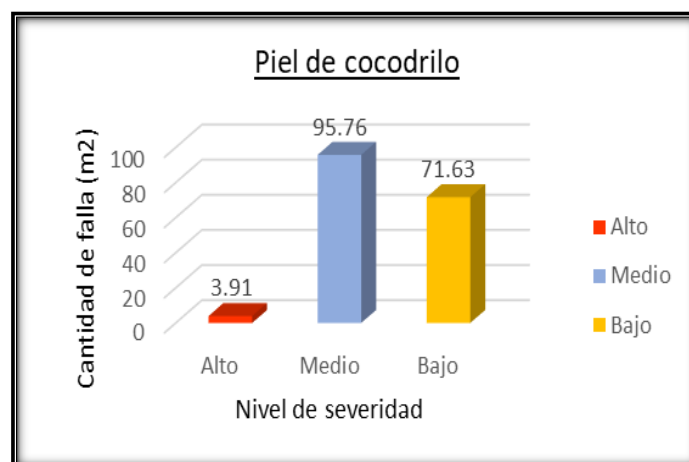
Figura 34. Nivel de severidad de piel de cocodrilo. Elaboración propia, 2018.
