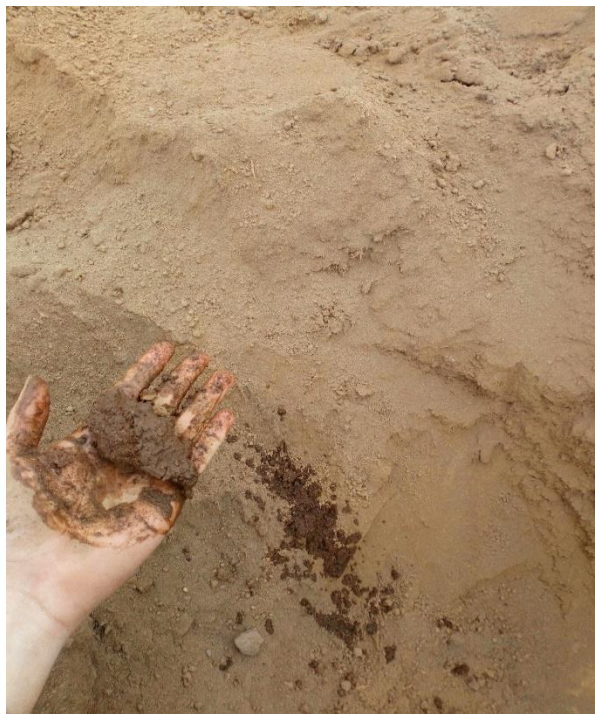
Figura 12. Prueba de compresión de la bola de la calicata N° 1
