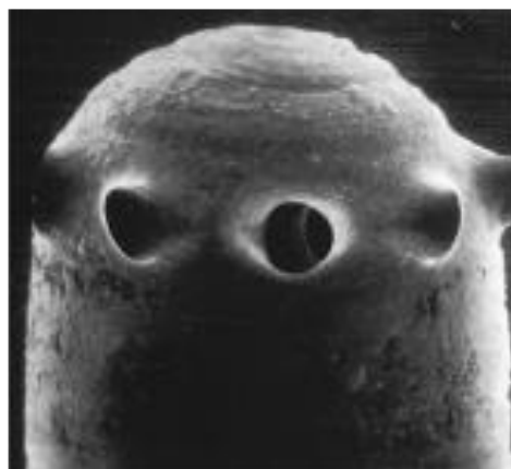
Figura N°4.2: Corte de un inyector con mantenimiento inadecuado del filtro de combustible
