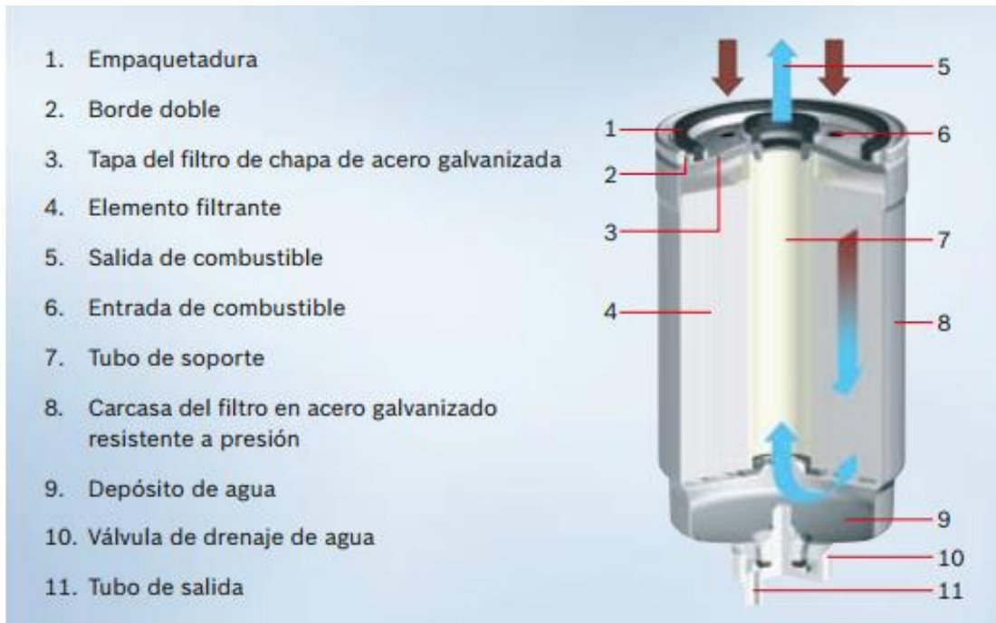
Figura N°1.8: Corte de un filtro convencional de combustible diesel.
