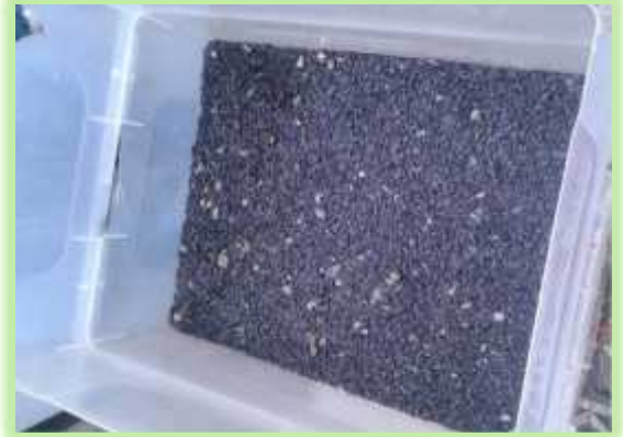
13. Sobre la mezcla de grava y tierra se adiciona 2 cm de carbón activado
