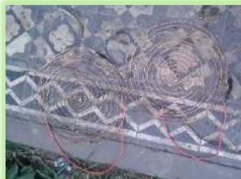
4. Tejido de hilos de cobre en forma de tela araña (Cátodo)
