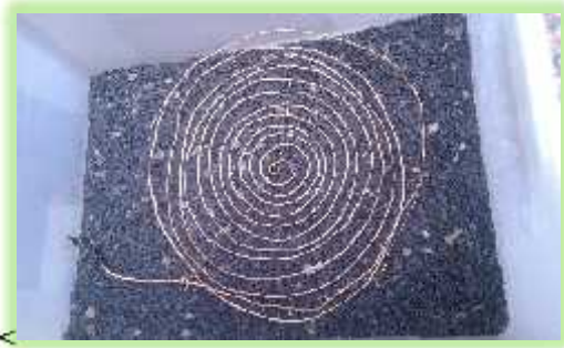
14. Adición de aspirar tejido con hilos de cobre sobre el carbón activado
