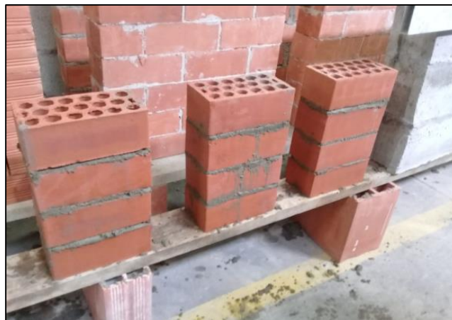
Figura 13: Pilas de Albañilería con Mortero Convencional
