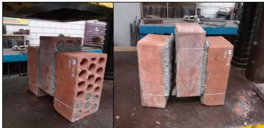
Figura 35: Ensayo de Adherencia al Cizalle en Maquina Universal con Mortero Embolsado UNICON
