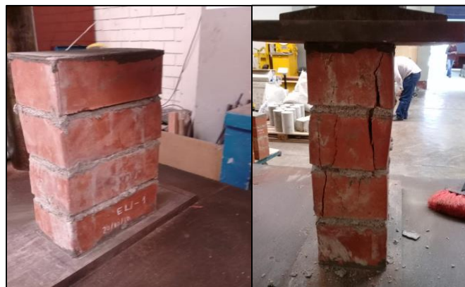
Figura 18: Ensayo de Compresión en Pilas Elaboradas con Mortero Embolsado “UNICON”
