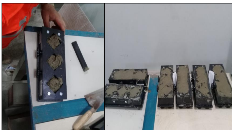
Figura 28: Mezclado del Mortero en Cubos y Compactado según NTP 334.051
