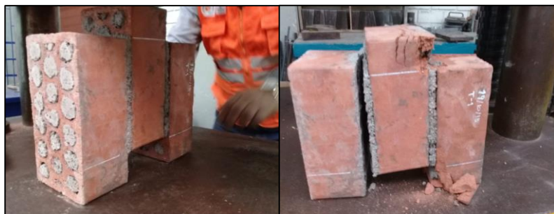
Figura 36: Ensayo de Adherencia al Cizalle en Maquina Universal con Mortero TOPEX
