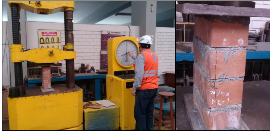
Figura 16: Ensayo de Compresión en Pilas realizado por un Técnico Especialista (Izquierda), Rotura de Pila con Mortero Convencional (Derecha).
