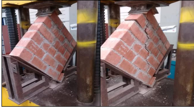
Figura 25: Ensayo de Compresión Diagonal en Murete con Mortero Convencional y el Modo de Falla Fuente: Elaboración Propia
