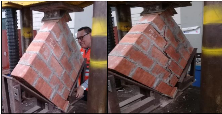
Figura 26: Ensayo de Compresión Diagonal en Murete con Mortero Embolsado “UNICON” y el Modo de falla Fuente: Elaboración Propia
