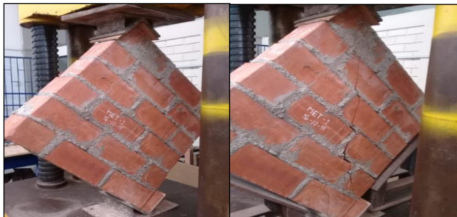
Figura 27: Ensayo de Compresión Diagonal en Murete con Mortero Embolsado “TOPEX” y el Modo de falla Fuente: Elaboración Propia
