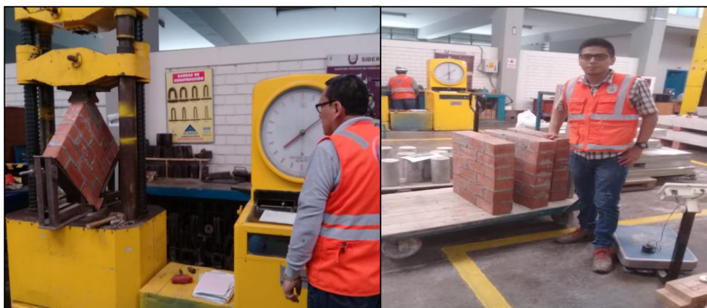
Figura 24: Ensayo de Compresión Diagonal en Muretes supervisado por el Técnico Especialista (Izquierda). Recolección de Muestras (Derecha)
