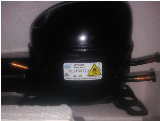
Figura 31 motor compresor R600a 1/10 Hp
