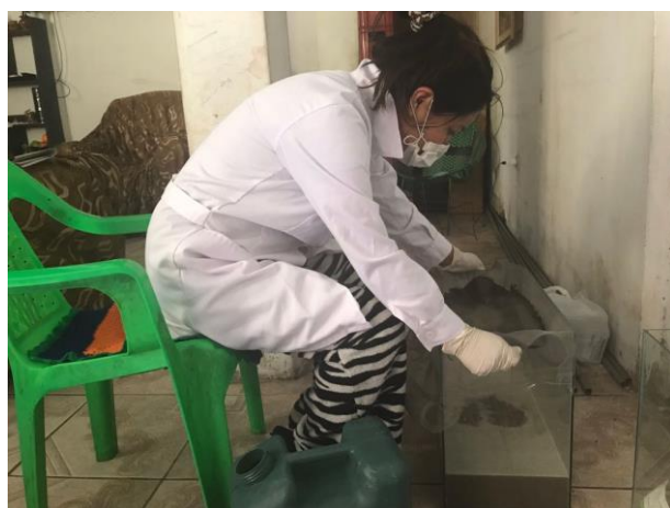
Figura N° 8. Filtración de la muestra con la malla (#27)
