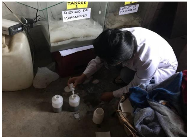
Figura N° 14. Adición de los conservantes ácido de zinc ( ZnO ) e Hidróxido de sodio ( NaOH )
