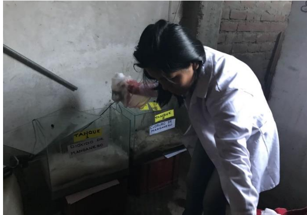
Figura N° 13. Muestreo respectivo de la muestra de cada tanque para su adición de los conservantes.
