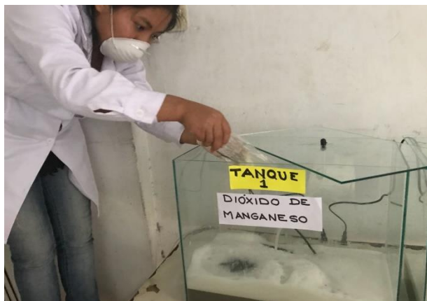
Figura N° 12. En el tanque 1 se agregó el 0.5% de dióxido de manganeso
