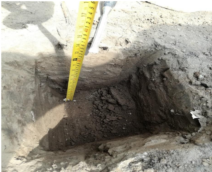
Figura N° 19. Medición de calicata
