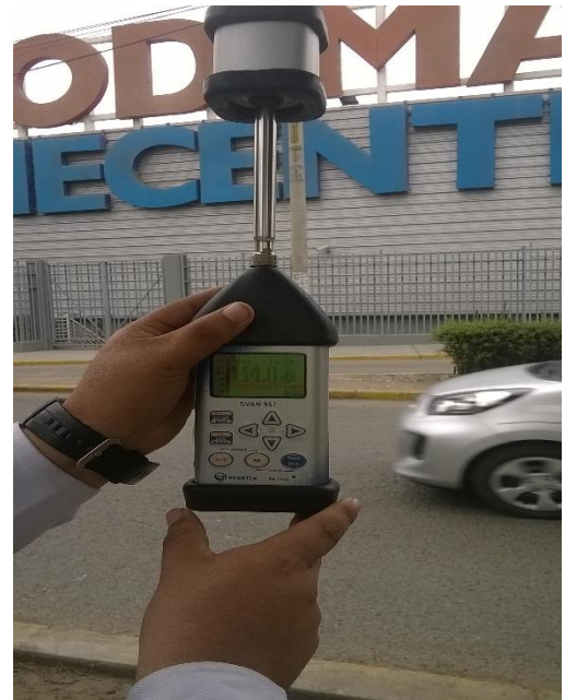
Fotografía N°4: Calibración del sonómetro en campo. Fuente: Propia
