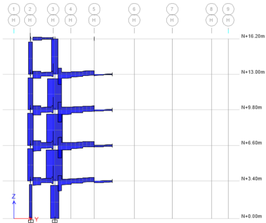
Figura 35: Diagrama de Fuerza Cortante en Vigas del Eje H-H
