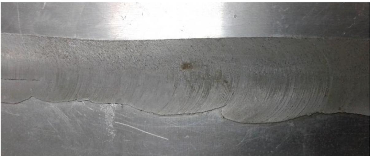
En vista fotográfica se observa el acabado del proceso soldadura FCAW-G a una temperatura de precalentamiento de 200°C
