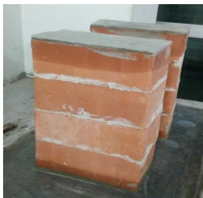
Figura 14. Aplicación del producto “Massa Dun Dun” en el ladrillo tipo V para pilas de albañilería
