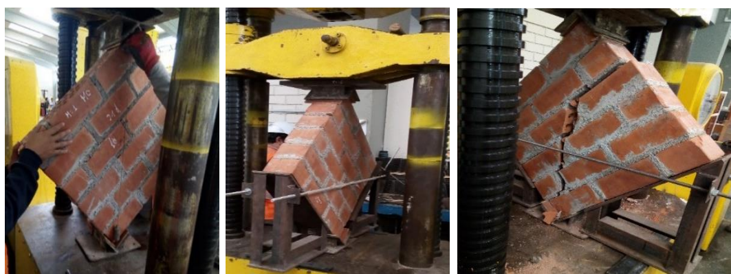
Figura 46. Ensayo de compresión diagonal de muretes con mortero convencional.
