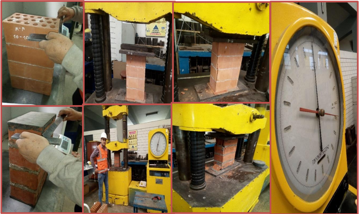
Figura 34. Toma de medidas; ensayo de compresión axial de pilas con mortero convencional y mortero polimérico de ladrillos Tipo A, B y C
