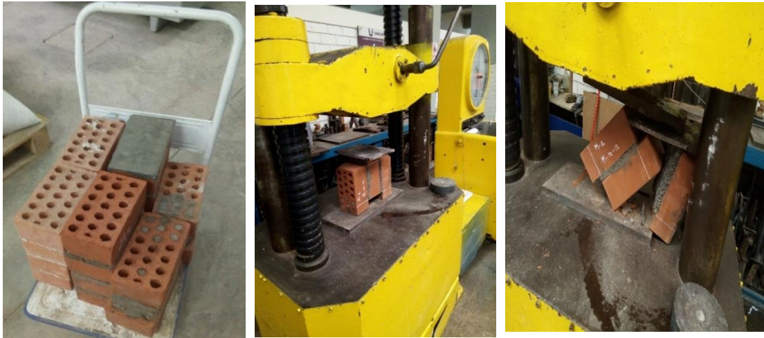
Figura 52. Se muestra el procedimiento del ensayo de adherencia con mortero convencional. Fuente: Fotos propias
