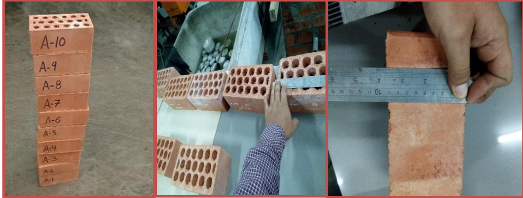
Figura N° 29. Muestras de ladrillo Tipo “A” para ensayo de variación dimensional. Fuente: fotos propias
