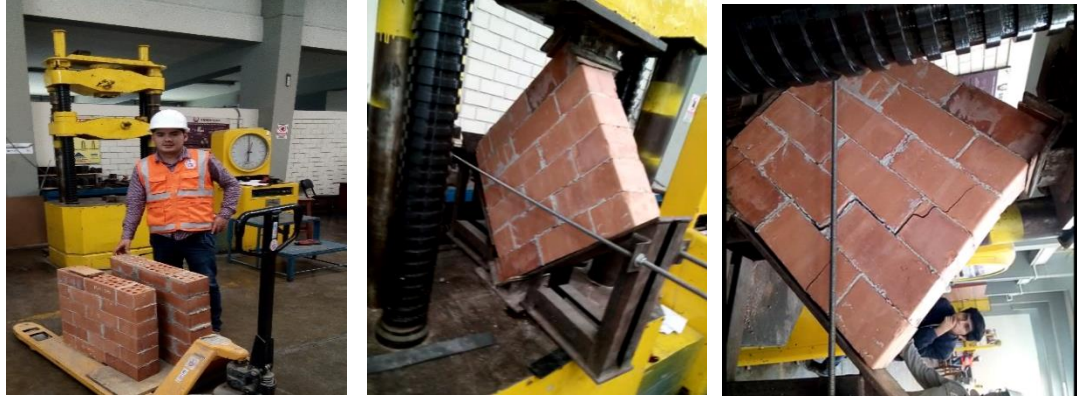
Figura 47. Ensayo de compresión diagonal de muretes con mortero polimérico.
