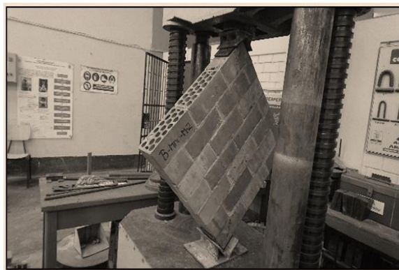
Figura 15. Observamos el modo de falla de los muretes.
