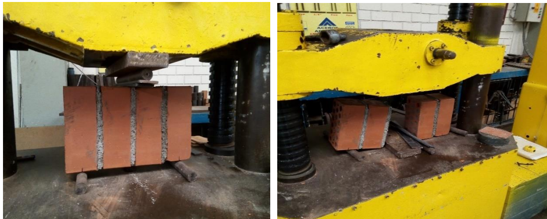
Figura 39. Ensayos de tracción por flexión en pilas con mortero convencional Fuente: fotos propias
