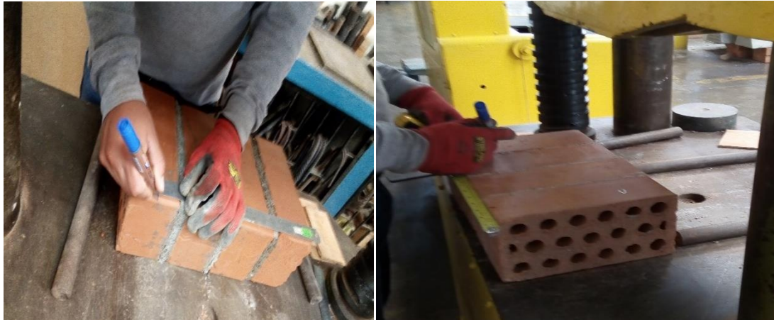
Figura 38. Medidas entre apoyos para ensayos de tracción por flexión en pilas Fuente: fotos propias
