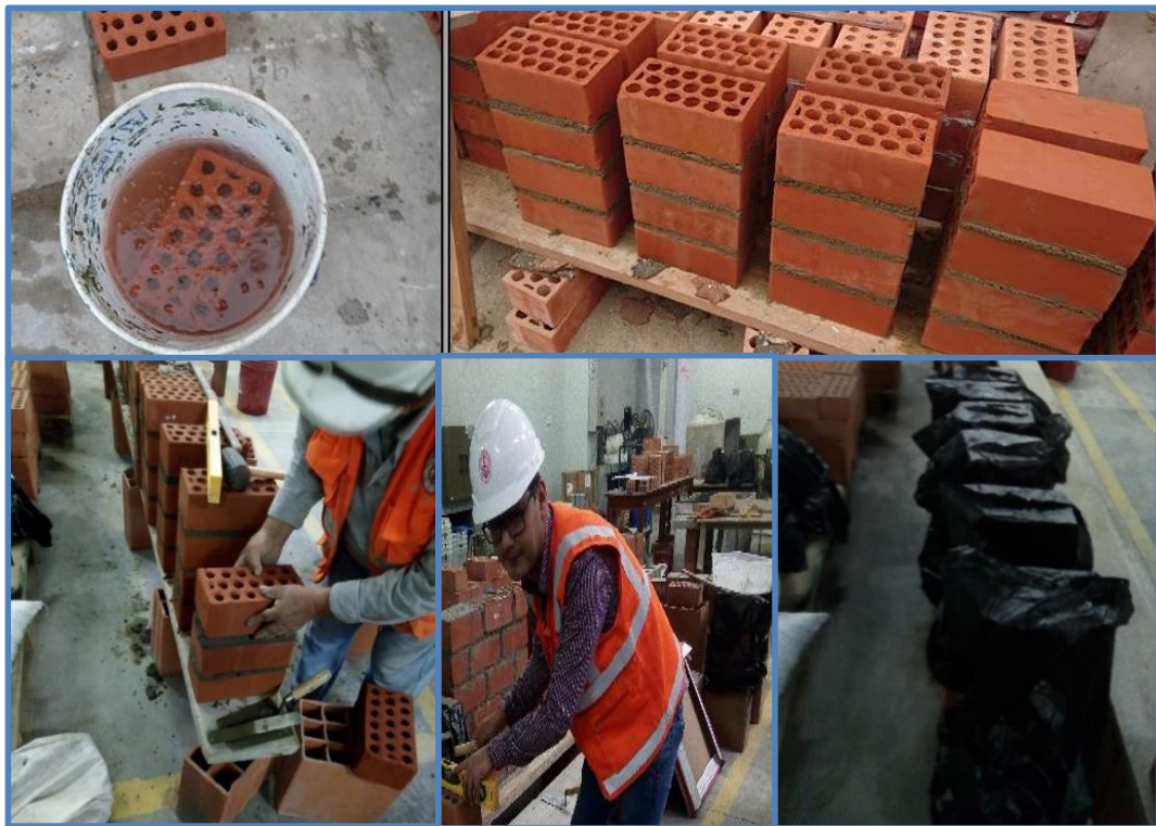
Figura 32. Saturación de la unidad de albañilería; Pilas de albañilería con mortero convencional de ladrillos Tipo A, B y C, nivelación y cubierta con bolsa de polietileno.
