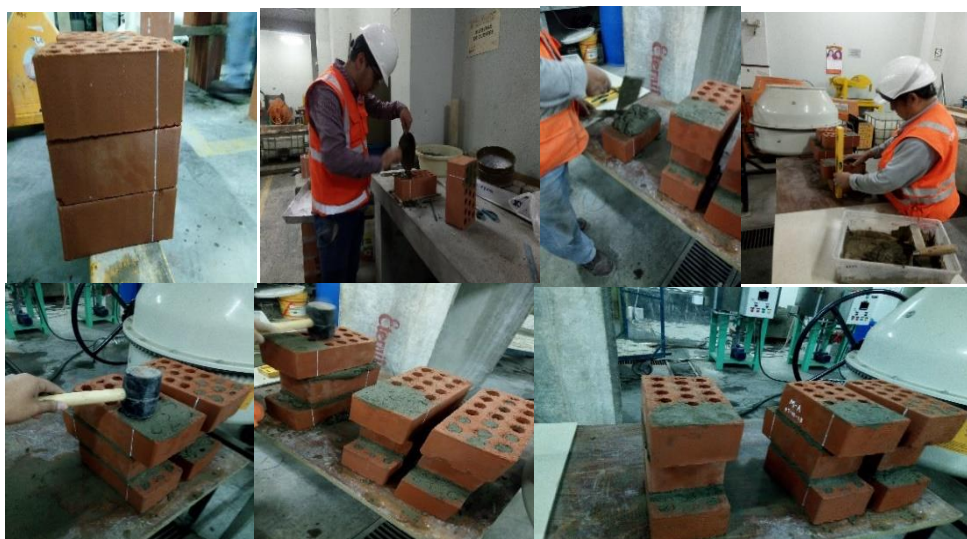
Figura 50. Saturación de la unidad de albañilería; tipo H de 3 unidades cruzadas de albañilería con mortero convencional de ladrillos Tipo A, B, nivelación y cubierta con bolsa de polietileno. Fuente: fotos propias
