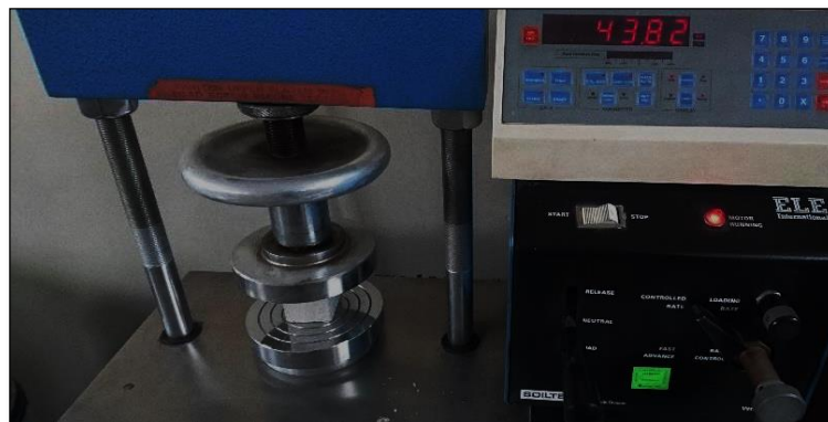
Figura 26. Aplicación de carga al espécimen de mortero.
