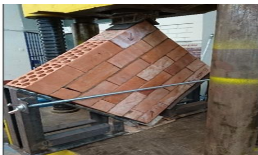
Figura 16. Ensayo de compresión diagonal en muretes empleando “Massa Dun Dun”
