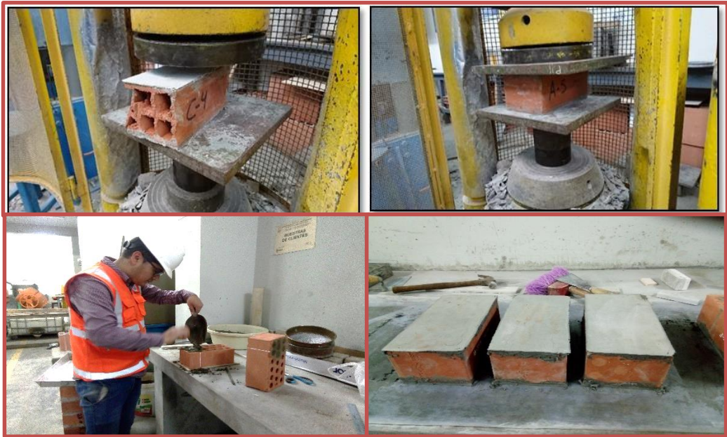
Figura 31. Ensayo de compresión en unidades de albañilería. Fuente: fotos propias
