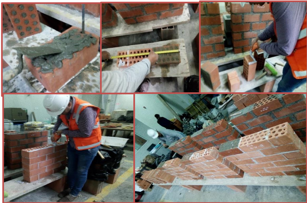
Figura 44. Observamos la aplicación del mortero polimérico “Massa Dun Dun”, así como la cantidad de material, para la elaboración de muretes de albañilería. Tipo A, Tipo B. Fuente: Fotos propias
