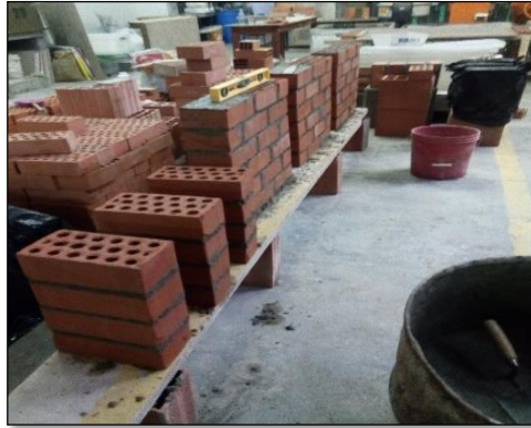
Figura 7. Muretes y pilas de albañilería con mortero convencional de ladrillos Tipo A.
