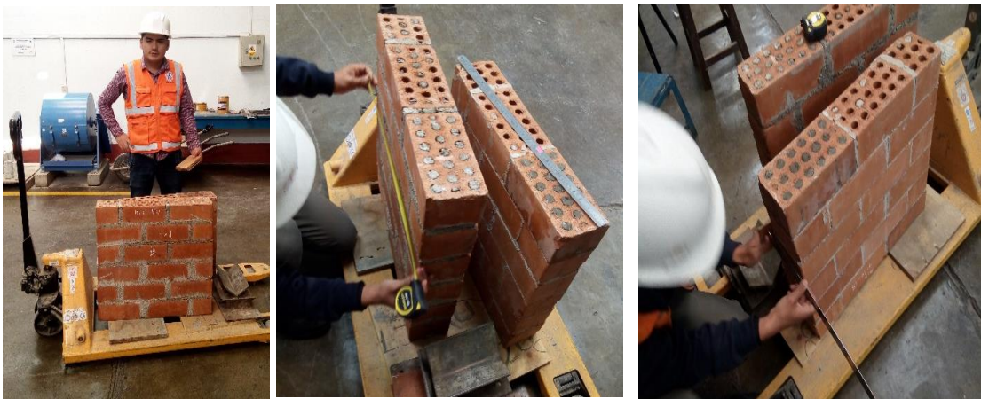
Figura 45. toma de medidas de los muretes antes de ensayar.
