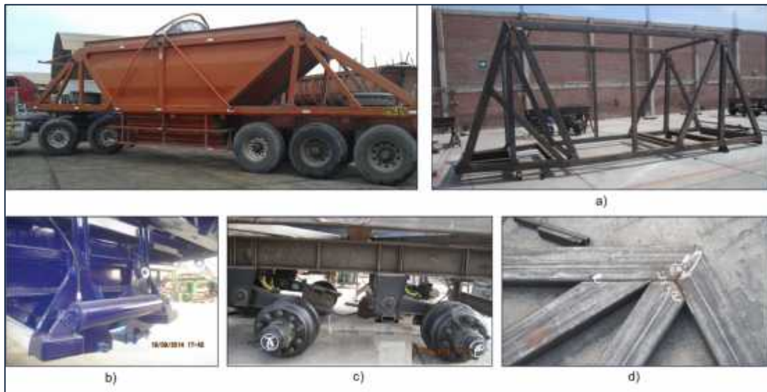
Figura N° 1 , Semirremolque tipo bombona y sus componentes, (a) Estructura de la tolva. (b) Sistema neumático para la descarga. (c) Chasis y suspensión neumático. (d) Tipo de unión en la estructura de la tolva.
