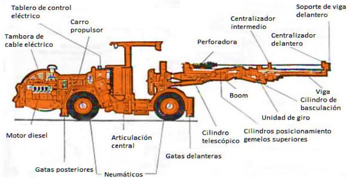
Fig.07. Partes principales de un jumbo hidráulico Fuente: Univ. Nacional Ing. Intr. Jumbos HYD
