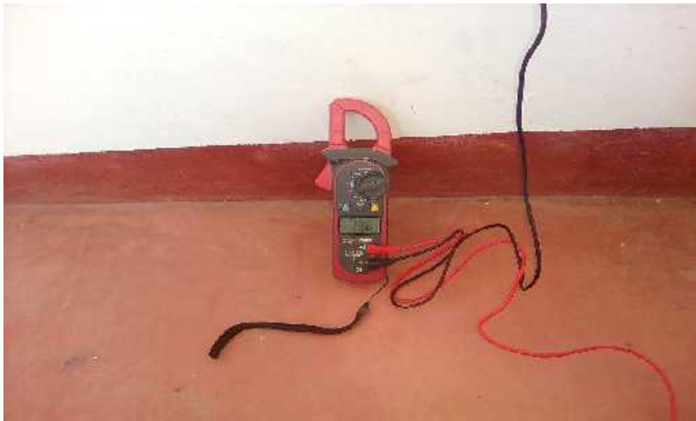
Gráfico (42) Medición de Tensión (valor adquirido 196 V)
