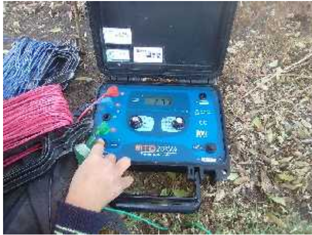
Gráfico (43) Telurómetro, Equipo de medición de puesta a tierra
