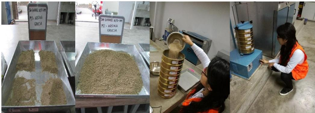
**Figura 29.** Cuarteo y tamizado de agregado fino
