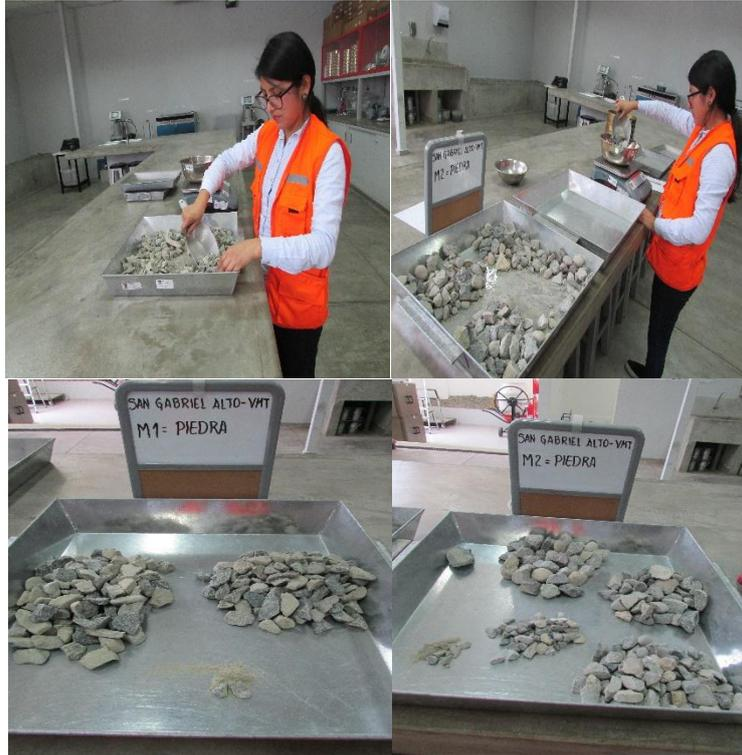
Figura 32. Muestras de agregado grueso
