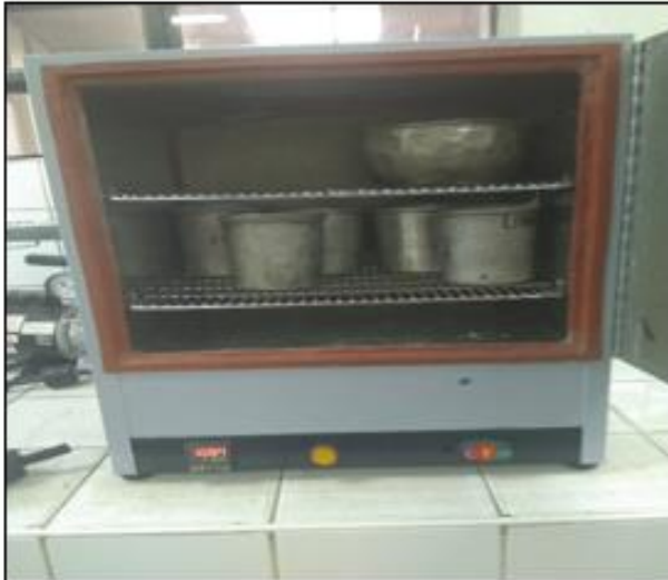
muestra en el Horno para el Limite Liquido
