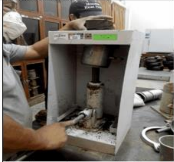
Se coloca en la prensa hidraulica que mediante una gata se extrae el molde
