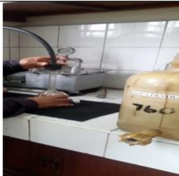
Extracción de Vacíos para determinar el peso especifico
