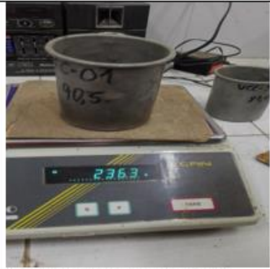
2 peso de muestra para llevar al horno a secar
