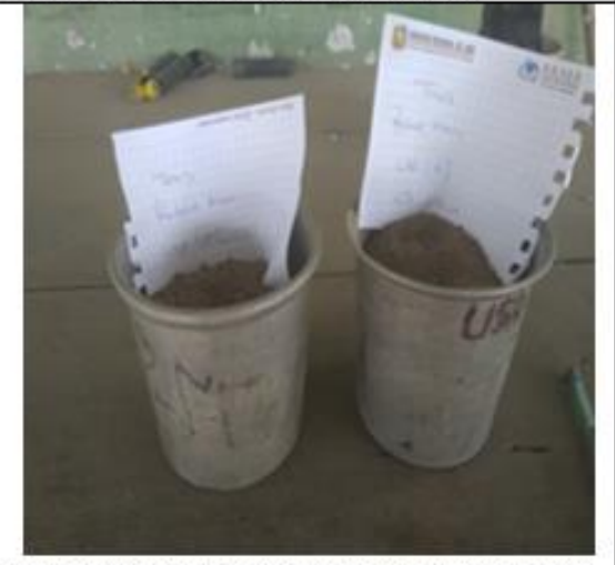
Muestras para la granulometria y los limites de Atterberg
