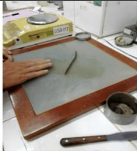
haciendo el proceso para determinar su plasticidad
