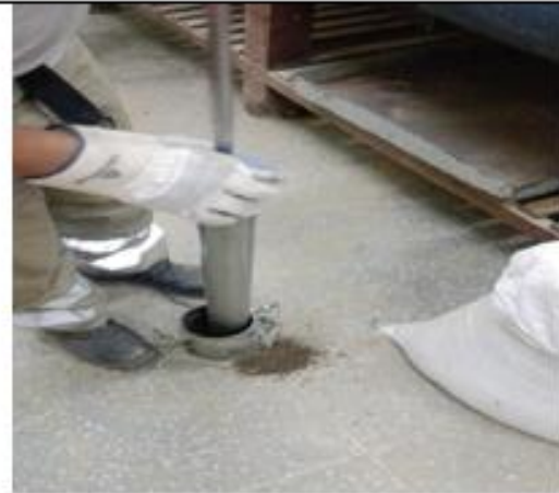
apisonando la primera capa de 25 golpes hasta la 5 capa
