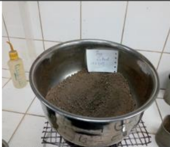
muestra para realizar el peso especifico
