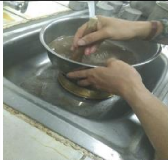
Realizando los trabajos de disgregamientos
