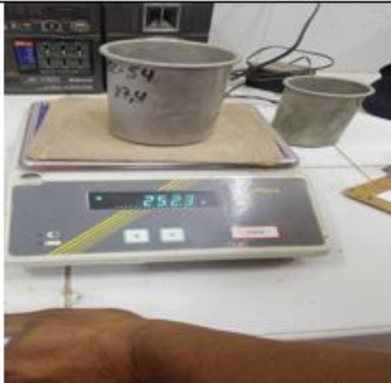
1 peso de muestra para llevar al horno a secar
