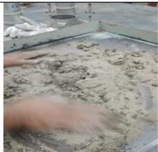
homogenizando la muestra con los 290 cc
