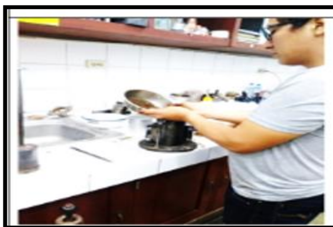
Figura 3.16. Realizando la compactación de los testigos.
