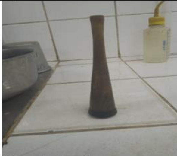
Disgregador de madera
