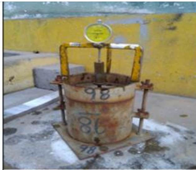
Figura 3.9. Molde del CBR, midiendo su expansión para someterlo a la poza por 4 días.
