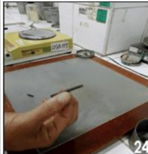
Calculando el Limite plastico sobre una superficie lisa dando el LP = 24
