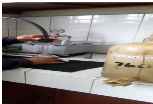
Figura 3.6. Calculando el Peso Especifico en la fiola,
