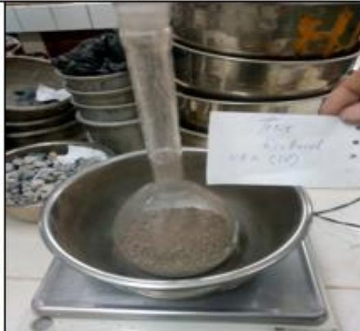
llenado en la fiola de vidrio que se lleno mediante un embudo
