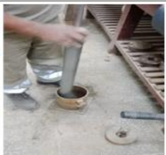
compactando a los 56 golpes con el piston.
