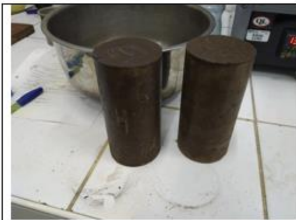
Despues de sellar todo el contorno del testifo
