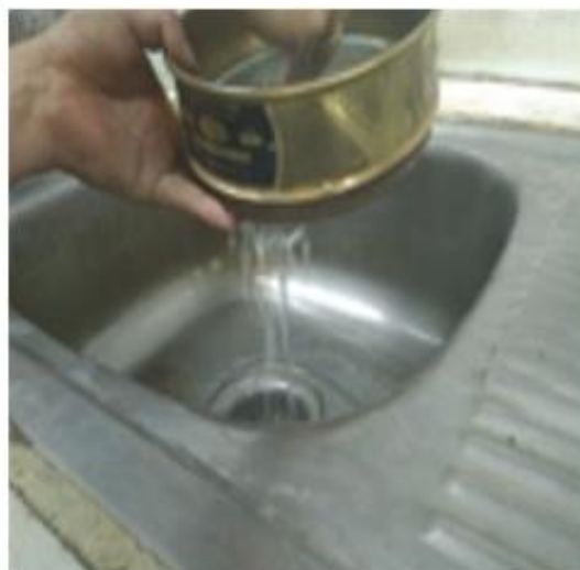
Lavado de la muestra hasta que el agua que excurra sea lo mas transparente
