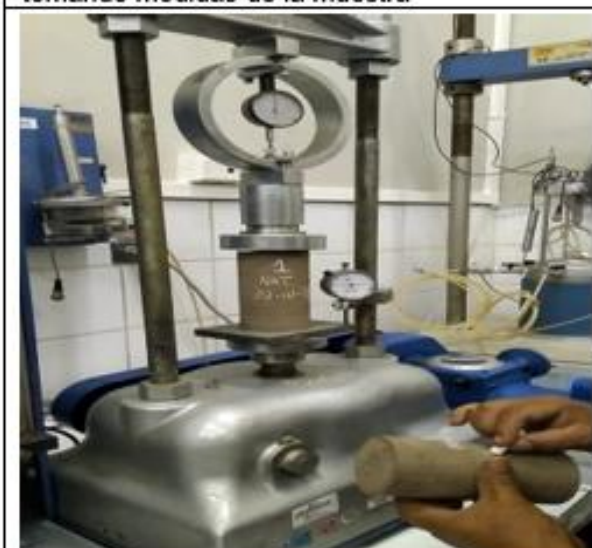
Primera muestra sometida a la compresion del terreno natural
