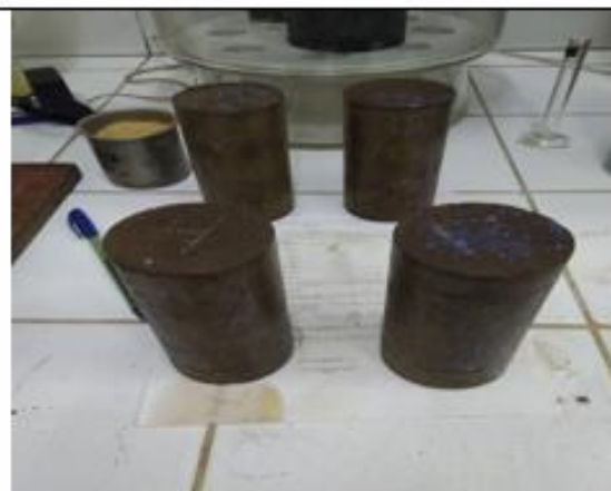
moldes una ves de terminado el sellado
