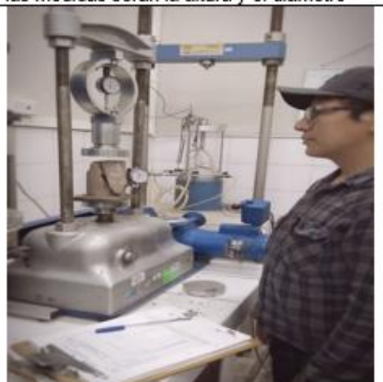
Se realiza la lectura y la anotacion del dial hasta que rompe
