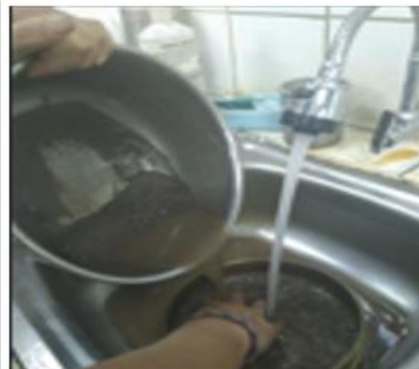
Lavado de la muestra y vertiendo por el tamiz # 40
