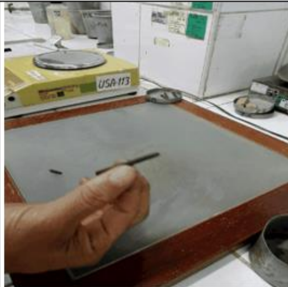
haciendo el proceso para determinar su plasticidad
