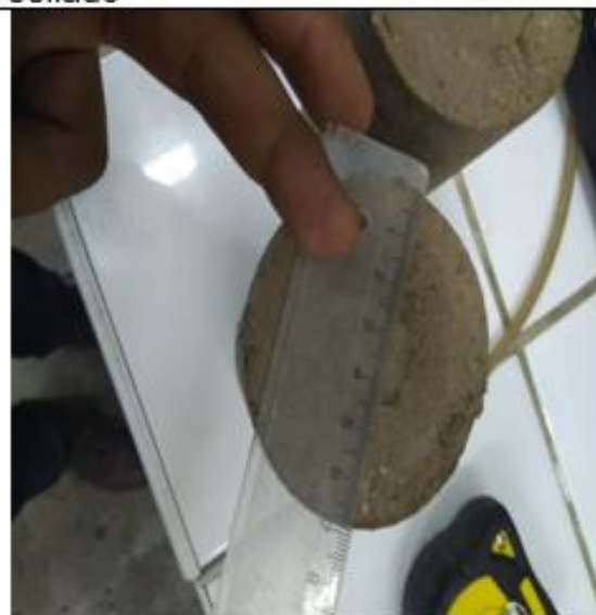
las medidas seran la altura y el diametro
