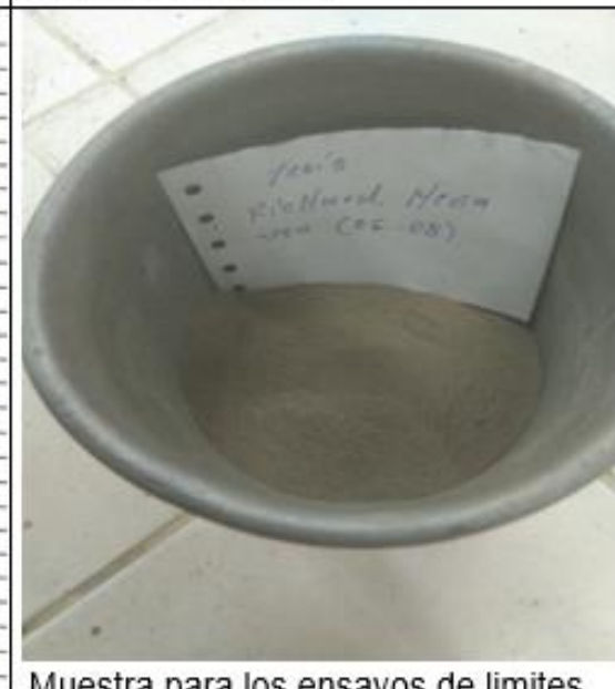
Muestra para los ensayos de limites liquidos y plasticos
