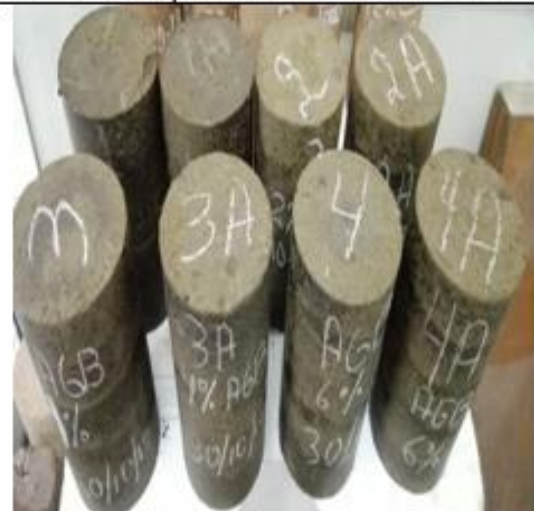
testigos obtenidos 2 de cada uno al natural, 2%, 4% y 6% dejando a temperatura ambiente por 14 dias para en el dia 15 realizar el ensayo.
