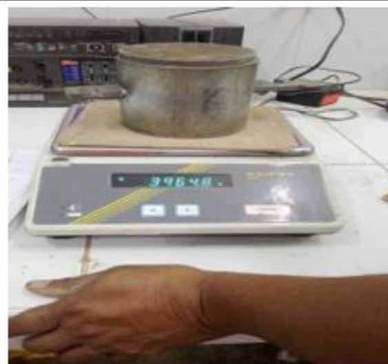
pesando la primera muestra teniendo la masa de suelo humedo + molde en gramos 3964.8 = 3965
