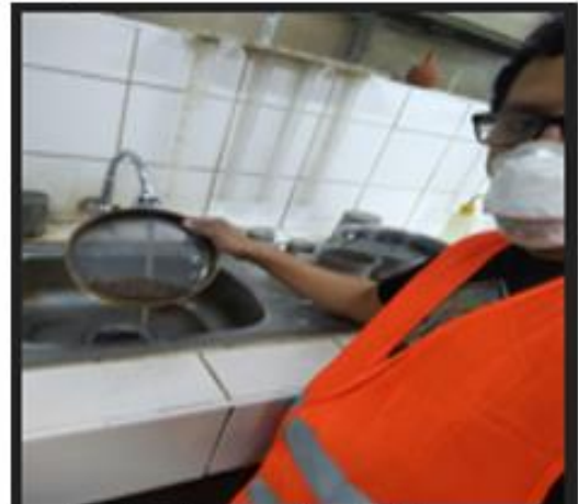
vertiendo de la malla n# 40
