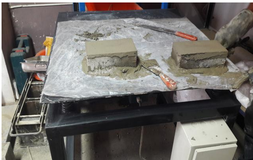
Figura 17. Refrentado de adoquines
