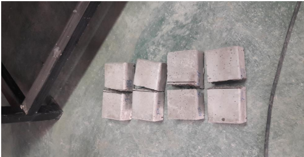
Figura 22. Adoquines sometidos al ensayo de módulo de rotura
