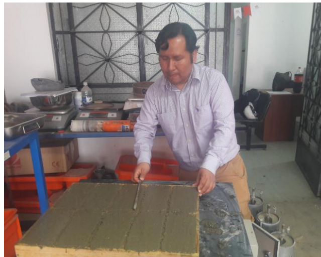
Figura 14. Vibrado del concreto en el molde del adoquín
