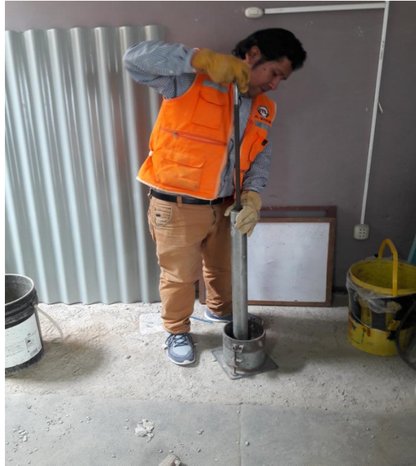
Figura 3. Molde y martillo para compactación proctor
