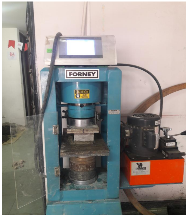
Figura 19. Ensayo a la resistencia de compresión del adoquín
