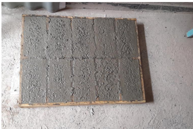
Figura 15. Fraguado del concreto en el molde del adoquín
