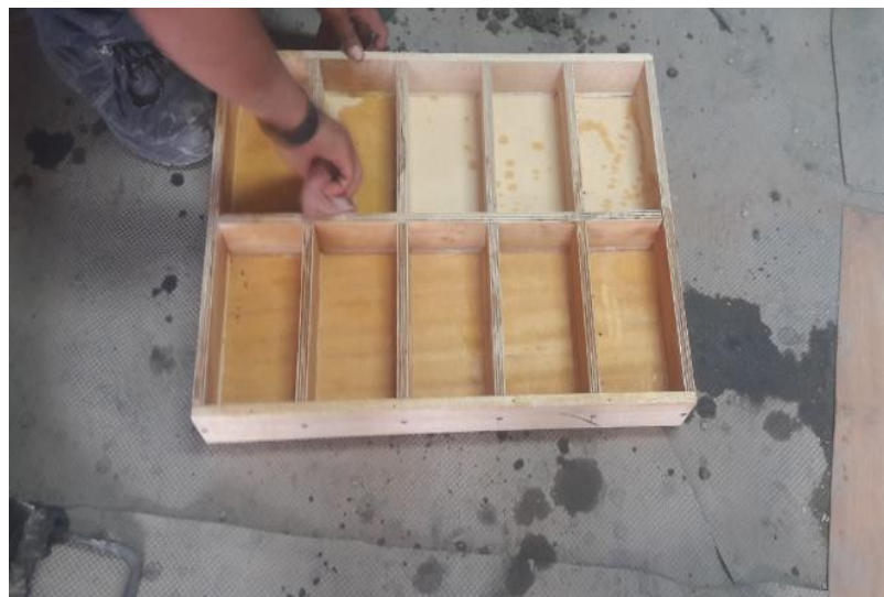
Figura 12. Molde de adoquines con petróleo
