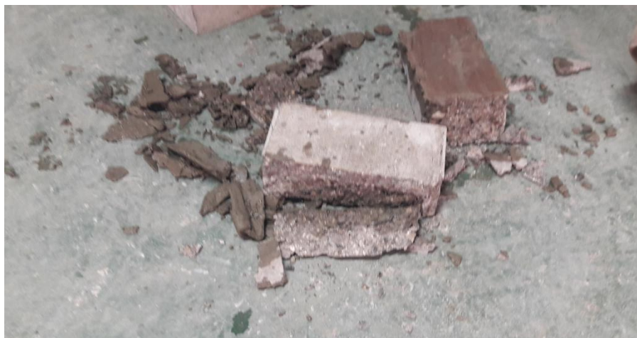
Figura 20. Adoquines sometidos a la fuerza de compresión
