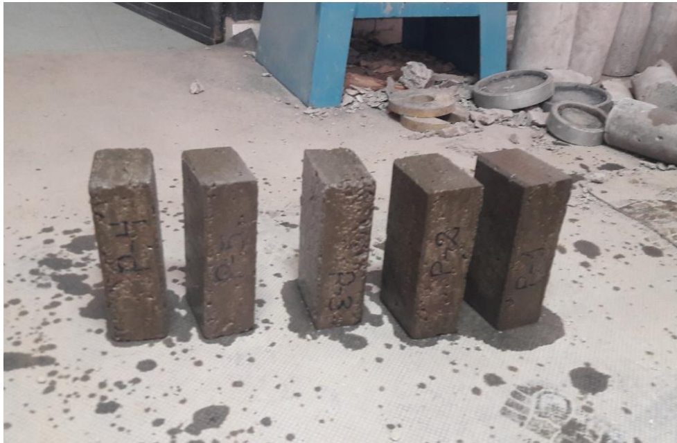
Figura 23. Adoquines saturados listos para llevar al horno
