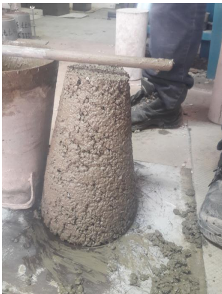
Figura 18. Ensayo de asentamiento del concreto usando el cono de Abrams
