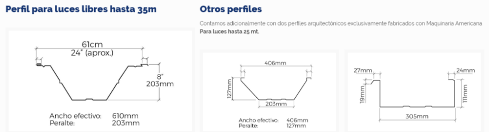
Figura 16. Características del perfil que cubre hasta 35m.
