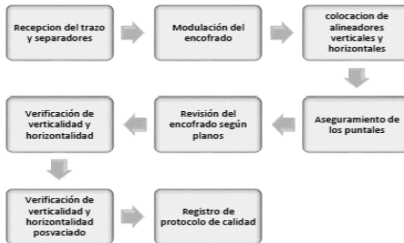
Figura 6.3 -1: Flujograma de Encofrado
