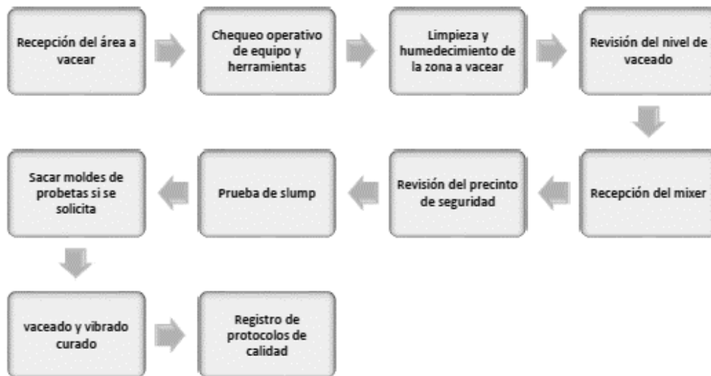
Figura 8-1: Flujograma de concreto
