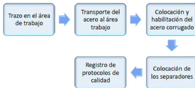
Figura 6.2 – 1: Flujograma de acero
