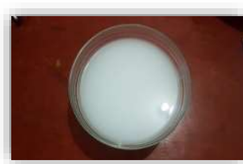
Foto N°23: Solución de cola sintética en agua.
