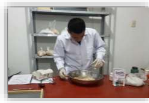
Foto N°20: Agregado del silicato de sodio a la muestra de bagazo de caña de azúcar.
