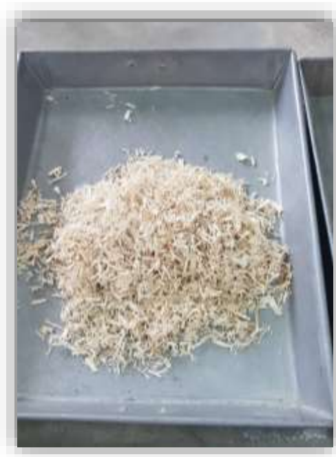
Foto N°9: Cantidad retenida de bagazo en la malla N° 4.
