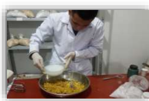
Foto N°24: Mezclado de cola y bagazo.
