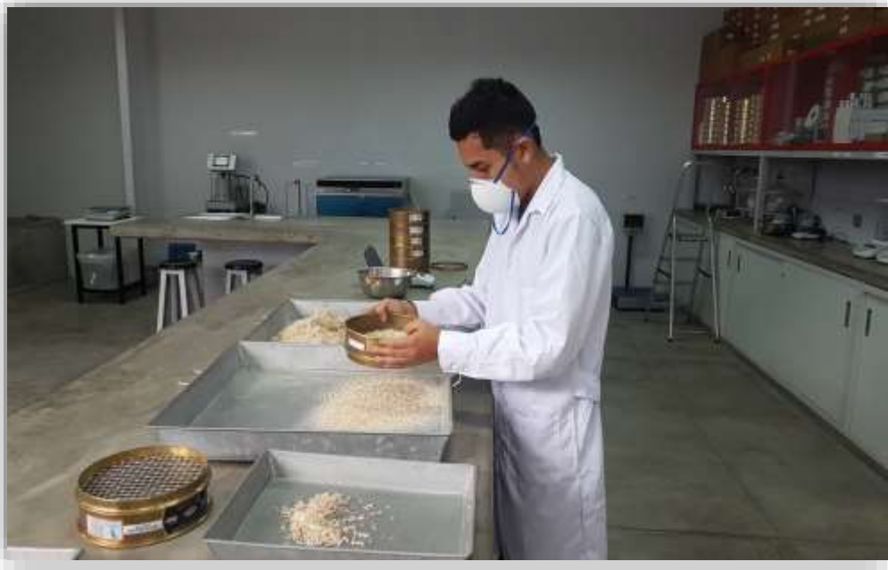
Foto N°8: Desarrollo de la granulometría por tamizado de mallas.
