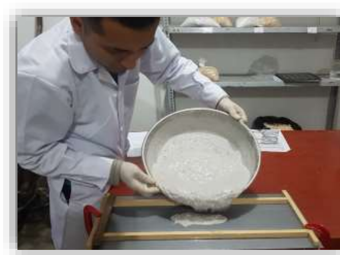
Foto N°26: Vaciado de la mezcla a los moldes.
