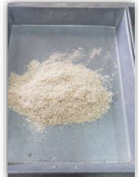
Foto N°12: Cantidad retenida de bagazo en la malla N° 18.
