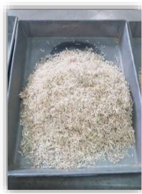
Foto N°10: Cantidad retenida de bagazo en la malla N° 8.
