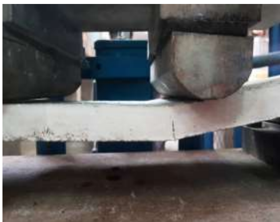
Foto N°32 Módulo de rotura.
