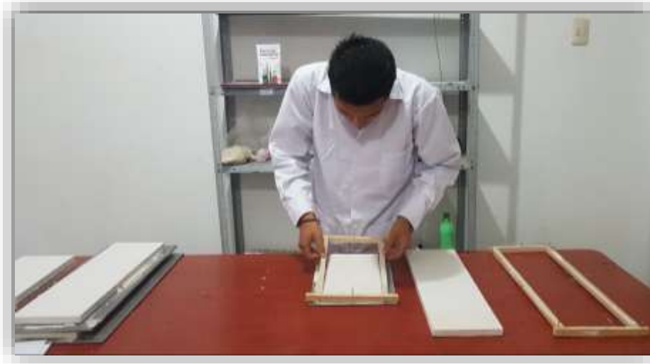
Foto N°27: Desmolde de las muestras.
