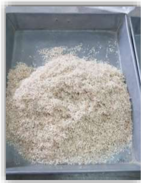
Foto N°11: Cantidad retenida de bagazo en la malla N° 16.
