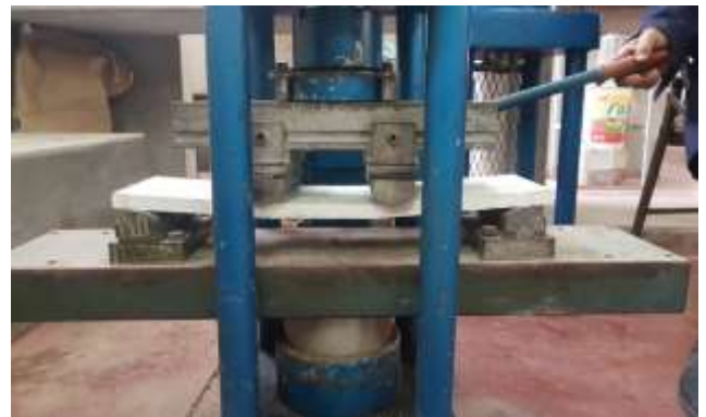
Foto N°30: Prueba de flexión.
