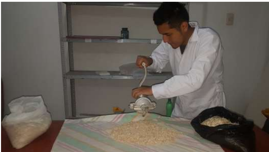
Foto N°6: Molido del bagazo de caña de azúcar.
