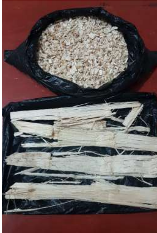
Foto N°5: Bagazo de caña de azúcar deshilarado y cortado en pequeñas partículas.
