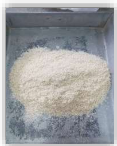
Foto N°13: Cantidad retenida de bagazo en la malla N° 30.
