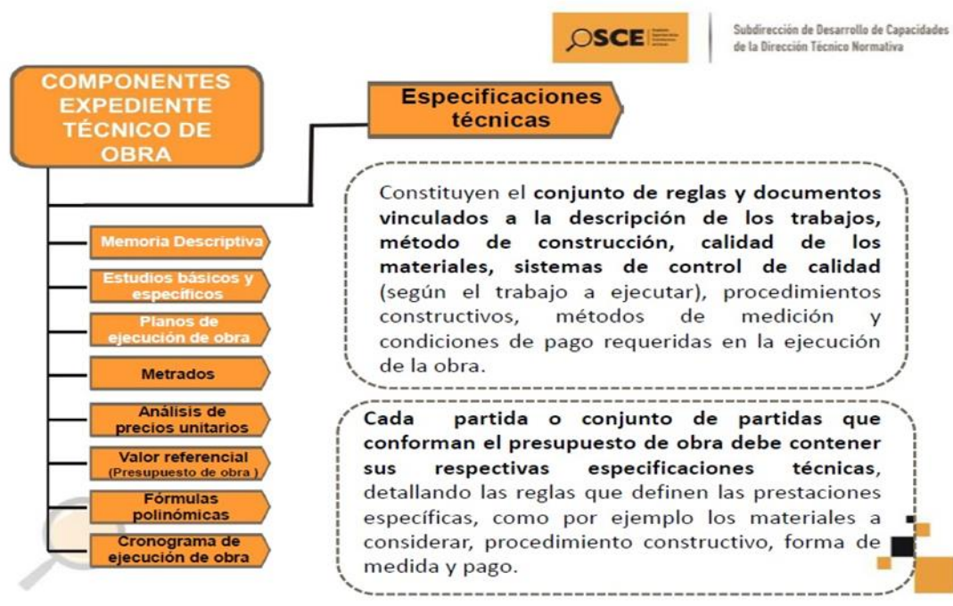
Figura 17. Componentes de un Expediente Técnico de Obra
