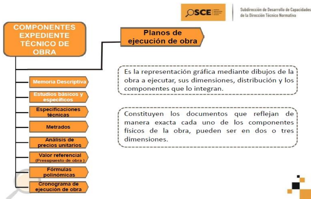
Figura 16. Componentes de un Expediente Técnico de Obra
