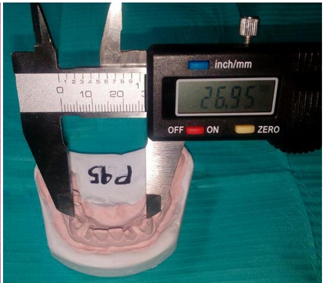
Figura 4. Medida de la distancia Intercanina realizado con el vernier digital.
