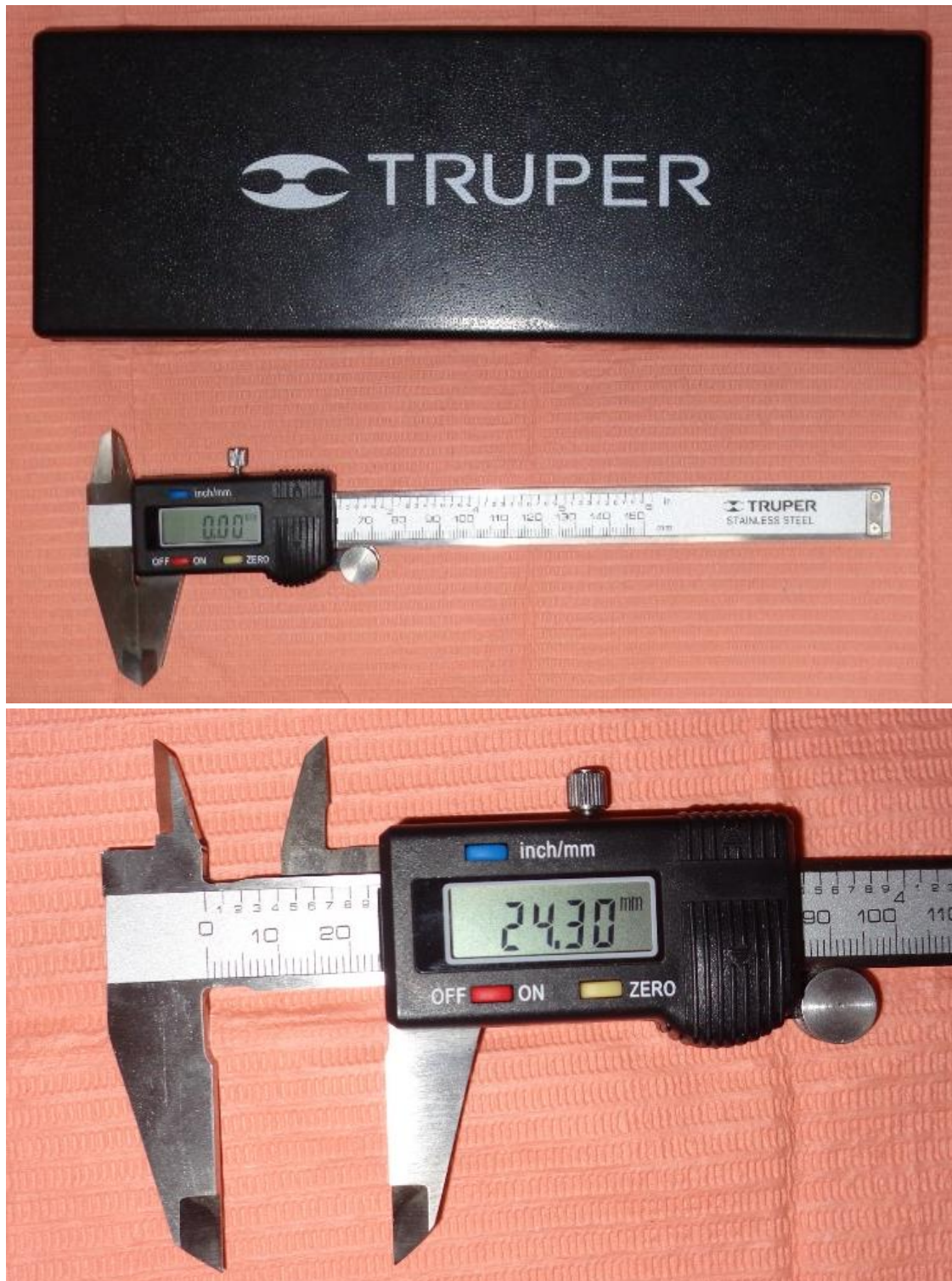
Figura 1: El instrumento de medición vernier digital, cuya medición se muestra en milímetros
