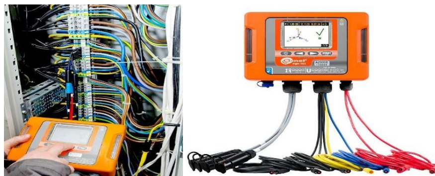
Figura 15: Analizador de calidad de energía PQM-703: Medición de Transitorios y Armónicos
