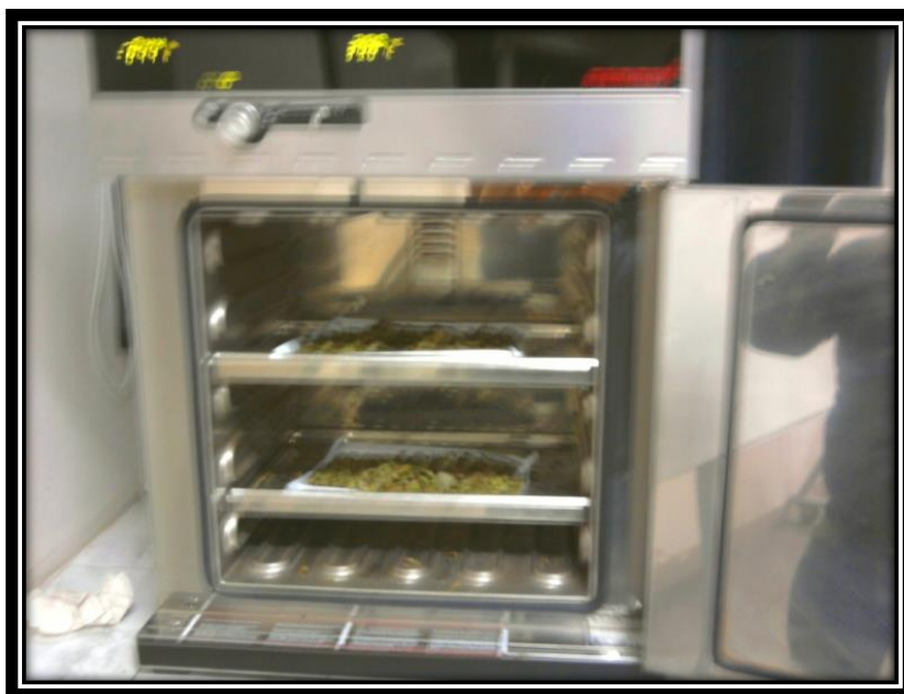
FIGURA 5. SECADO DE LAS HOJAS – TIEMPO: 72 - HRS T: 37C
