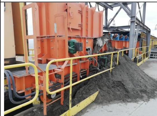
Imagen 22: Car-tripper: Derrame de materia prima lado derecho
