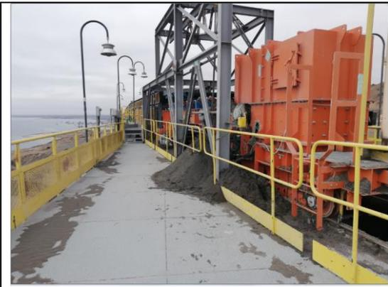
Imagen 24: Car-tripper: Derrame de materia prima lado izquierdo
