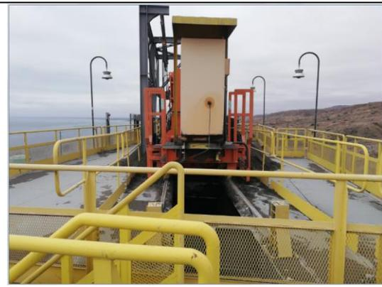
Imagen 25: Car-tripper: Derrame de materia prima lado frontal
