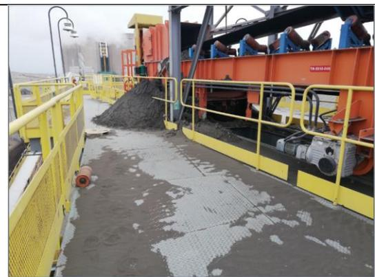
Imagen 23: Car-tripper: Derrame de materia prima lado derecho.
