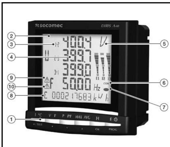
1. Teclado compuesto por 6 teclas de doble función (visualización o configuración)
