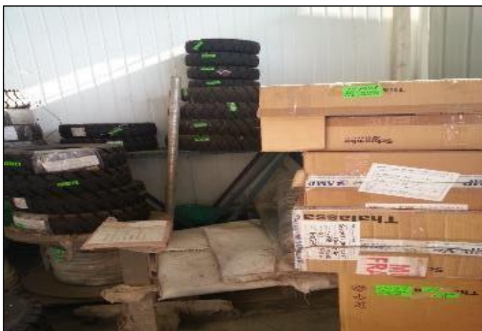
Figura 17. Almacén sin clasificación y elementos innecesarios.
