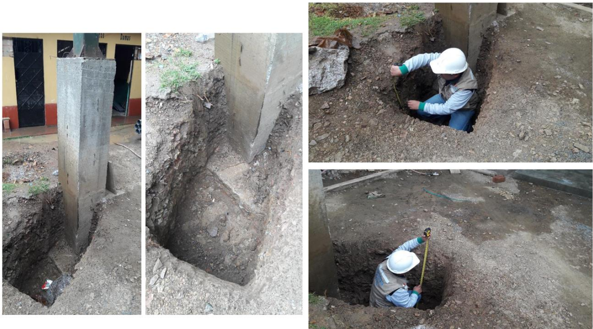
Fotografía 5: Evaluación de las zapatas y recojo de muestra de suelo
