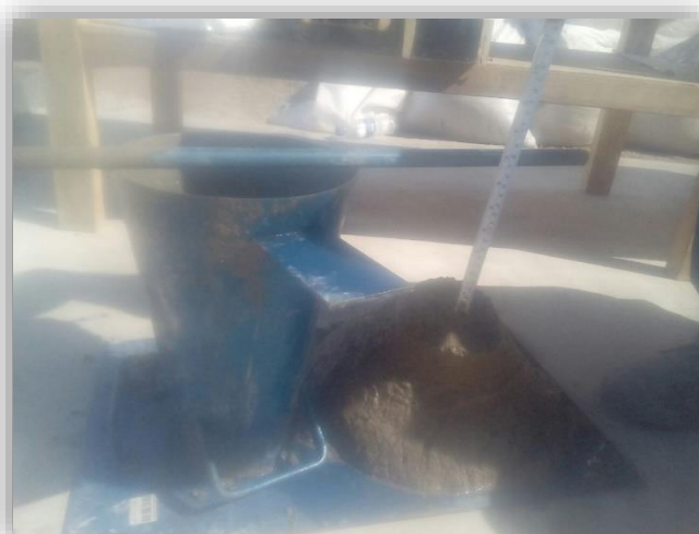
Figura III-19: Slump del mortero con 3% de Plastico Reciclado
