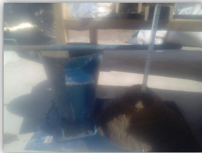
Figura III-21: Slump del mortero con 8% de Platico Reciclado
