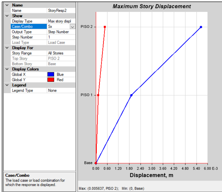
Figura 28: Mximo desplazamiento de entrepiso de la vivienda 1 reforzada con placa de concreto armado – sismo en eje Y. Fuente: propia.
