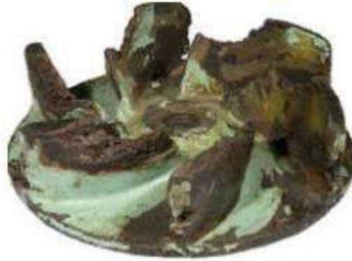
Figura 17. Efectos de la cavitación
