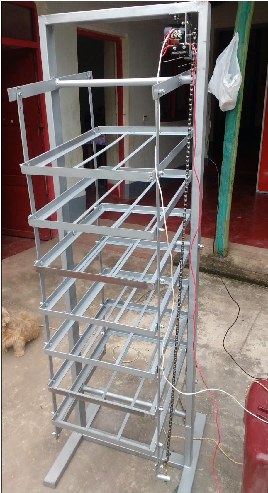
Foto n°4. Estructura metálica del soporte de las bandejas nacederas y pruebas del volteo automático – vista lateral.
