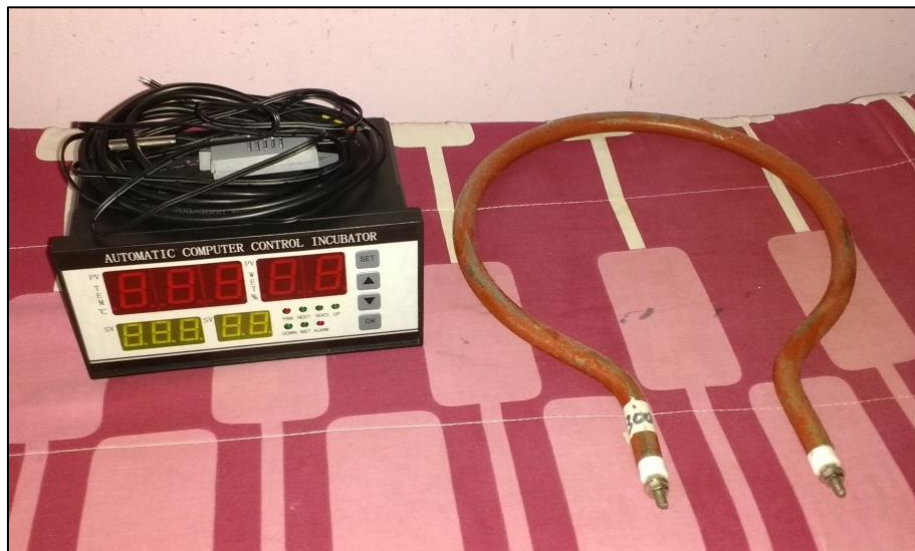
Foto n°2. Dispositivos de control y resistencia
