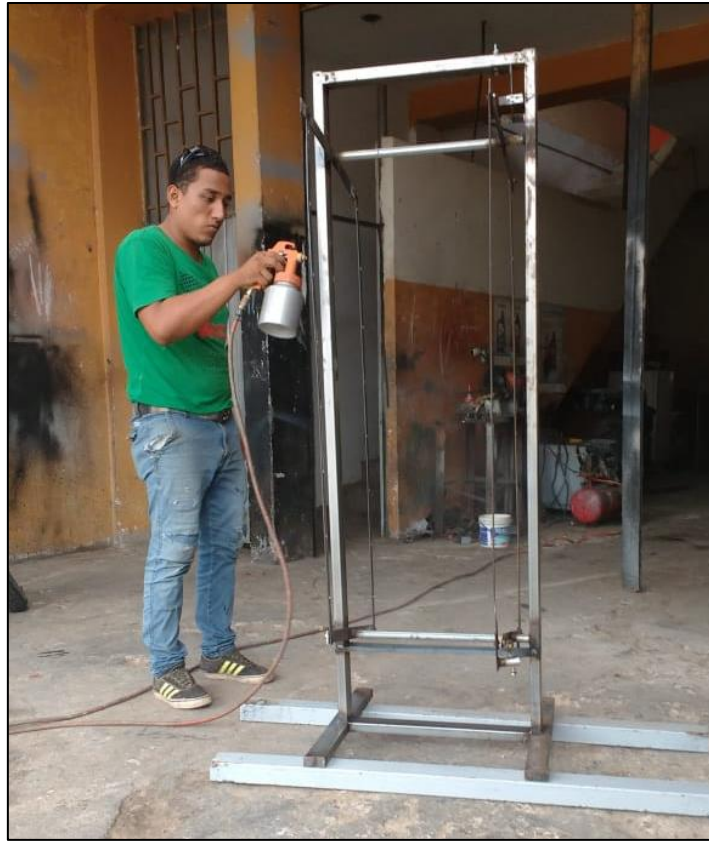
Foto n°1. Confección y pintado del marco metálico de la incubado
