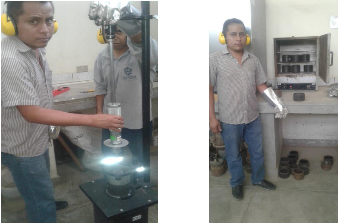
Figura 19. Compactación de la mezcla (Fuente: propio)
