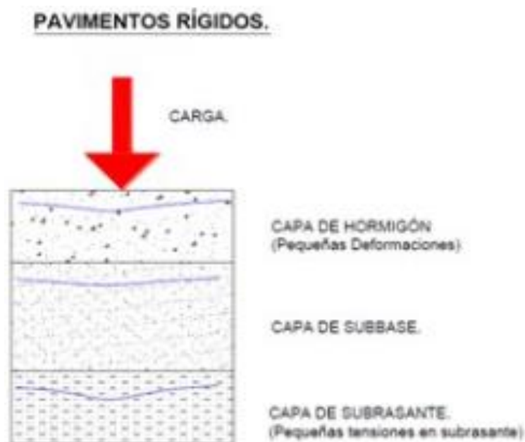
Figura 2 Capas de Pavimento rígido (Fuente: Propia)
