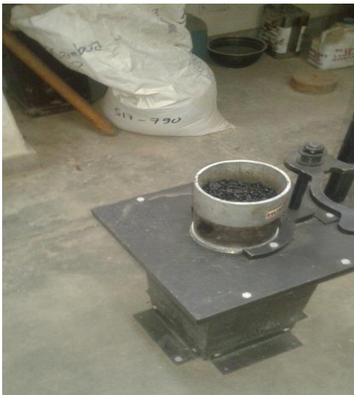
Figura 18. Colocación de la mezcla en el molde (Fuente: propia)
