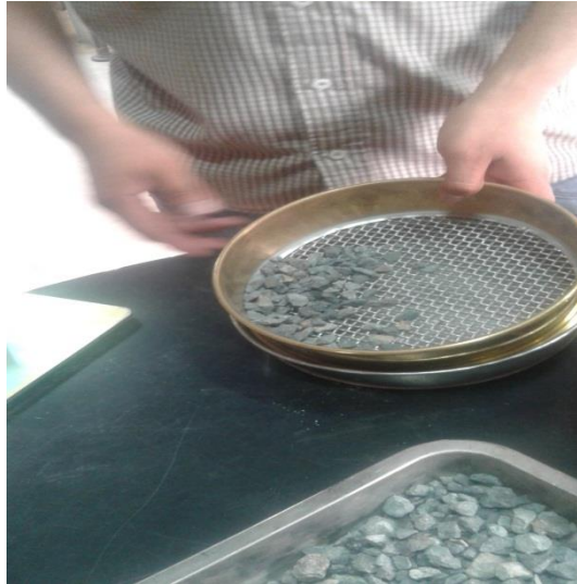
Figura 11. Verificación de cada partícula del agregado grueso para determinar cada una de ellos si contiene caras fracturadas
