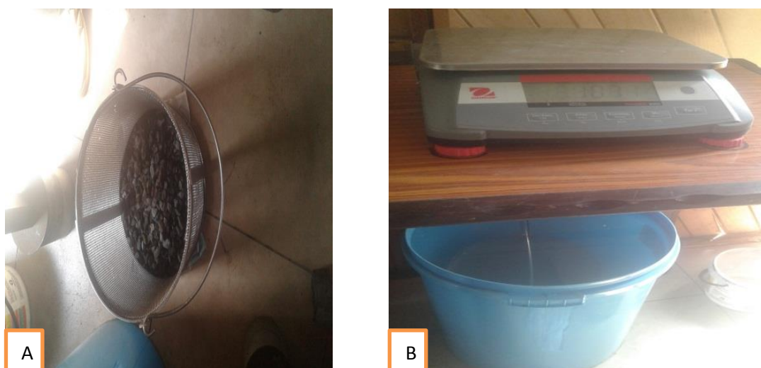
Figura 6. La muestra de las partículas gruesa en la canastilla para sumergir en el agua llevando así al balde con una profundidad que cubra toda la canastilla.
