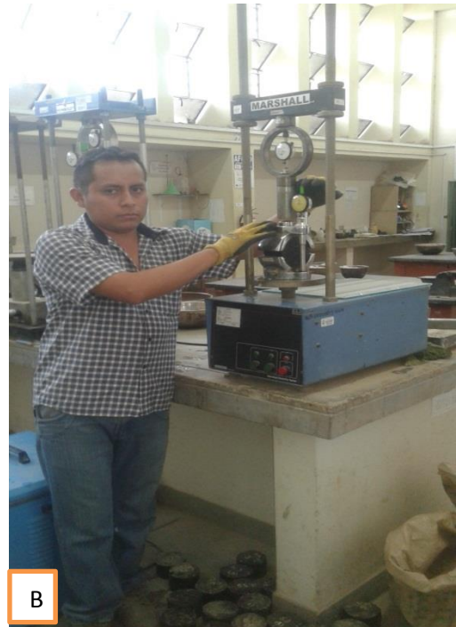
Figura 20. A) Colocación del molde en baño María B) determinación de la estabilidad en el ensayo de Marshall
