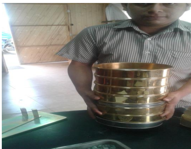
Figura 12. Determinación de cada porcentaje de agregados que pasa y retiene, que representa en cada tamiz al momento de realizar movimientos circulares.
