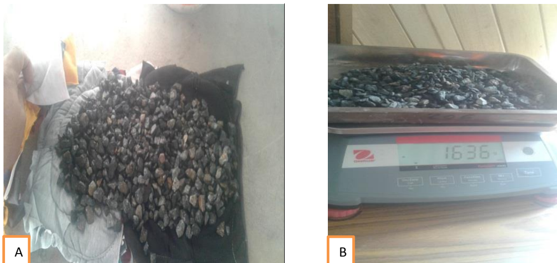
Figura 5. Proceso de secado con una franela o paño de las partículas después de las 24 horas en el agua durante el proceso se lleva a la balanza para obtener el peso de la condición saturada superficialmente seca.
