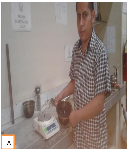
Figura 23. A) Peso del agregado a 0.5gr B) agregando la disolución en los tubos de ensayo
