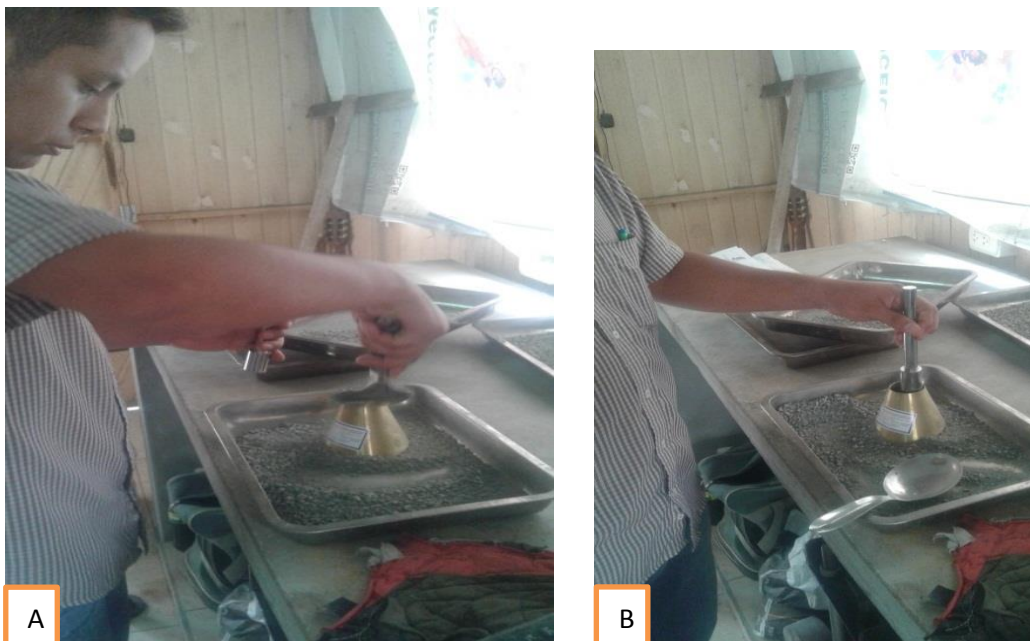
Figura 7. Realización del agregado fino en el molde cónico para la compactación de 25 golpes hasta rellenar el cónico.
