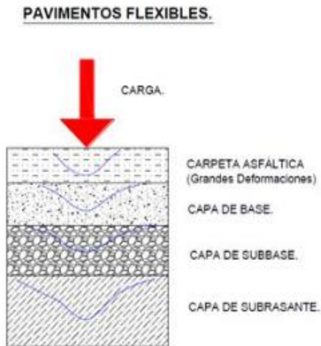
Figura 1 Capas de Pavimento Flexible
