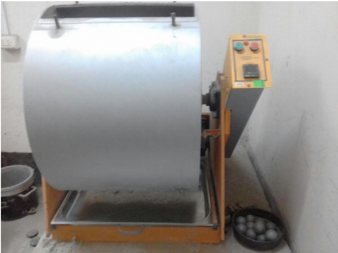
Figura 9 Realización en la máquina de los ángeles para la trituración del agregado grueso con 11 esferas
