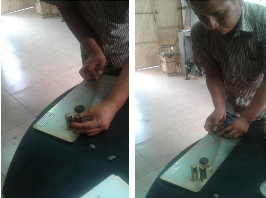
Figura 10. Determinación del agregado grueso en el calibrador para 200 unidades de la partícula, para verificar cuantas son partículas chatas o alargadas.
