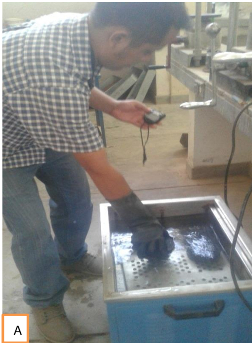
Figura 20. A) Colocación del molde en baño María B) determinación de la estabilidad en el ensayo de Marshall
