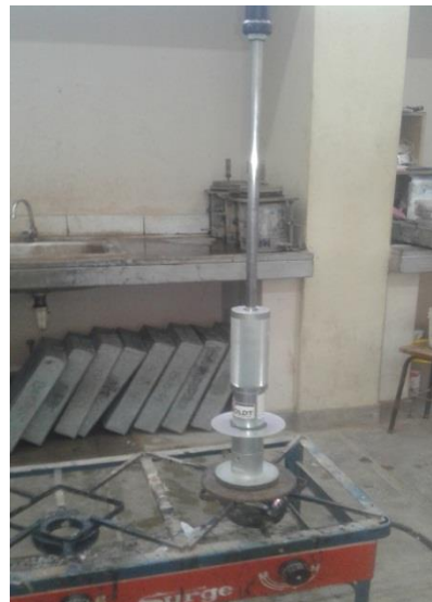
Figura 18. Colocación de la mezcla en el molde (Fuente: propia)
