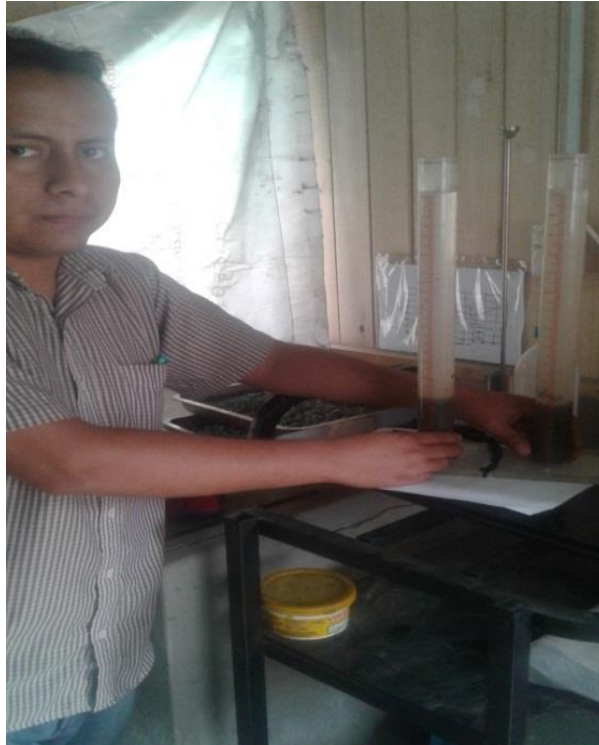
Figura 8 Realización del porcentaje de equivalente de arena (Fuente: propia)
