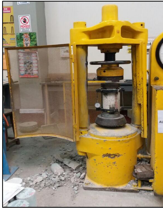
Ensayo a compresión de concreto Celular
