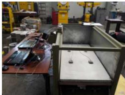
Fig 3. Equipo de ensayo de resistencia al fuego.
