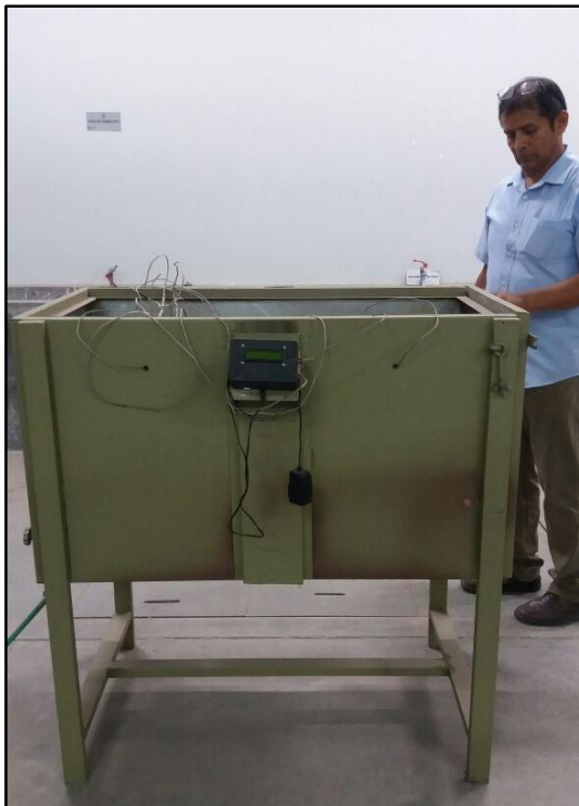
Ensayo termico de concreto Celular
