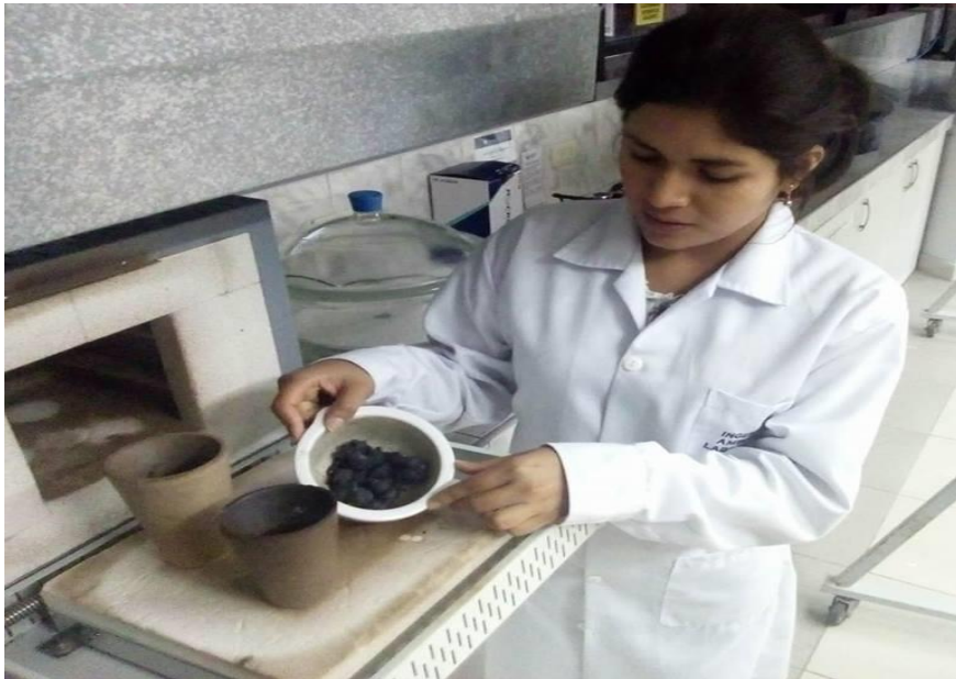
Figura 15: Retiramos las semillas carbonizadas de la estufa
