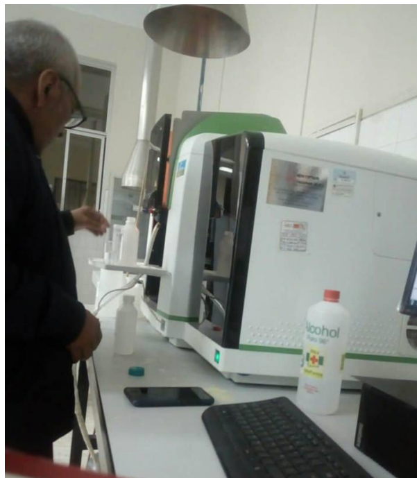
Figura 25: Análisis de impregnación del \text{Fe}^{+3} por absorción atómica
