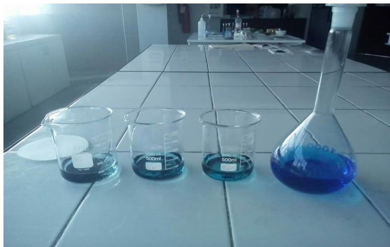
Figura 19: Soluciones de carbón activado a temperatura de 300°C (azul), 500°C (azul medio) y 700°C (ligeramente azul)
