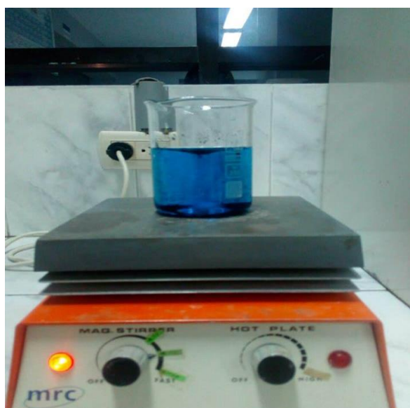
Figura 23: Velocidad de agitación a 300 rpm, para la impregnación del carbón activado con Fe
