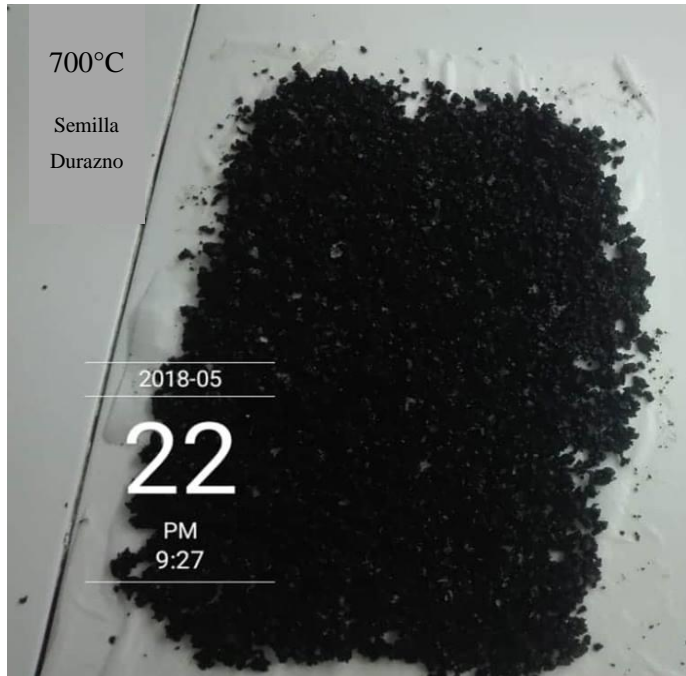
Figura 20: Carbón activado preparado a 700°C
