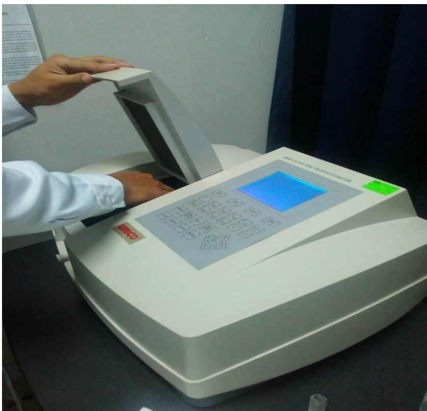
Figura 22: Se llevaron a leer la absorbancia en un espectrofotómetro UNICO 2800 UV-VIS, a 660 nm.
