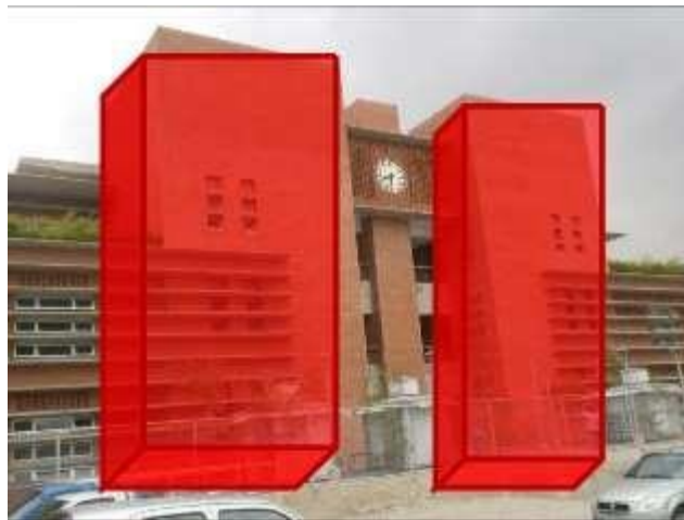
Figura 50: Paralelepípedos idénticos que contienen núcleos de escaleras y ascensores – Fuente google.
