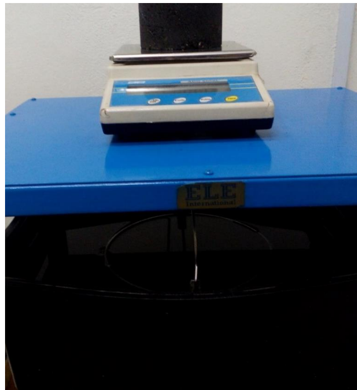
Figura 43: Peso de briqueta antes y después de ser sumergido en agua
