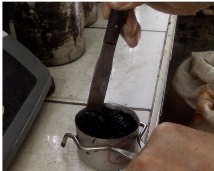
Figura 34: Mezcla de cemento asfáltico con el agregado fino
