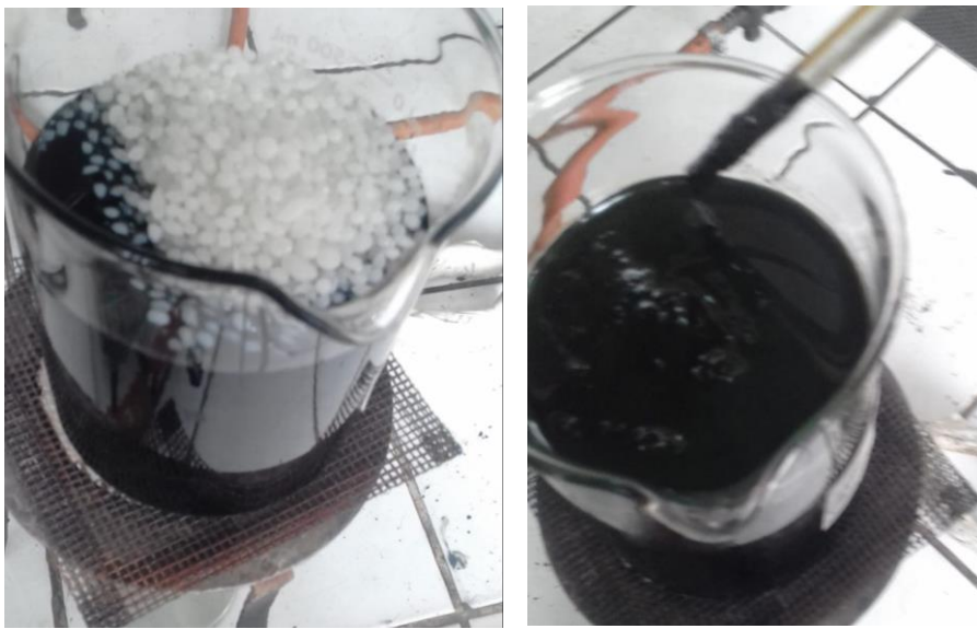
Figura 50: Cemento asfáltico adicionando aditivo Sasobit
