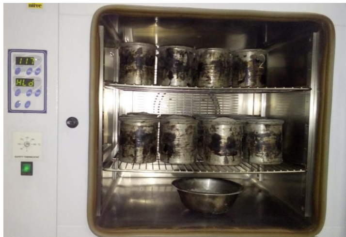
Figura 39: Tarros con la mezcla de agregados en horno a 117°C
