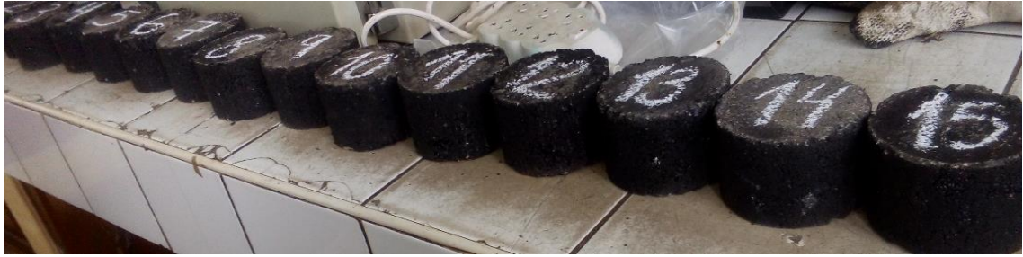
Figura 41: Briquetas enumeradas de acuerdo al contenido de % asfalto
