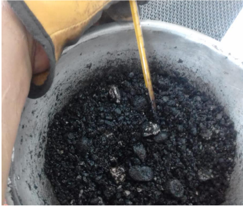
Figura 52: Medida de temperatura de la mezcla asfáltica con aditivo Sasobit
