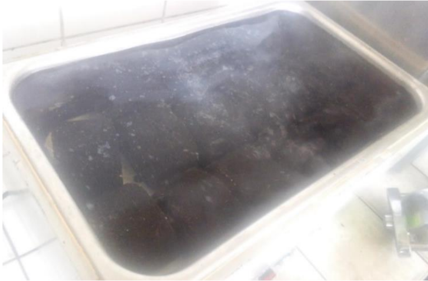
Figura 44: Briquetas sumergidas en agua de 60°C
