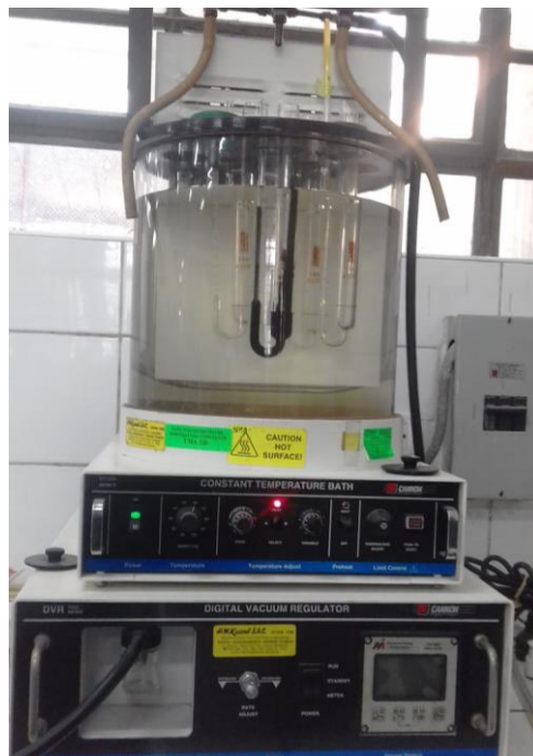
Figura 37: Baño viscosímetro de temperatura constante
