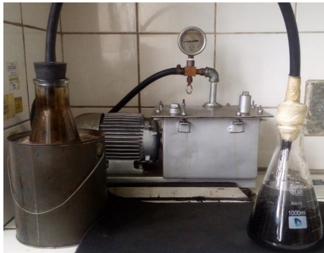
Figura 47: Extracción de vacíos de la mezcla asfáltica
