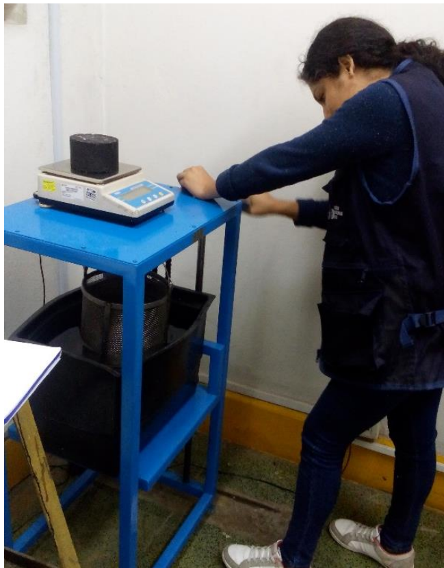
Figura 57: Medición del peso de la briqueta en el aire
