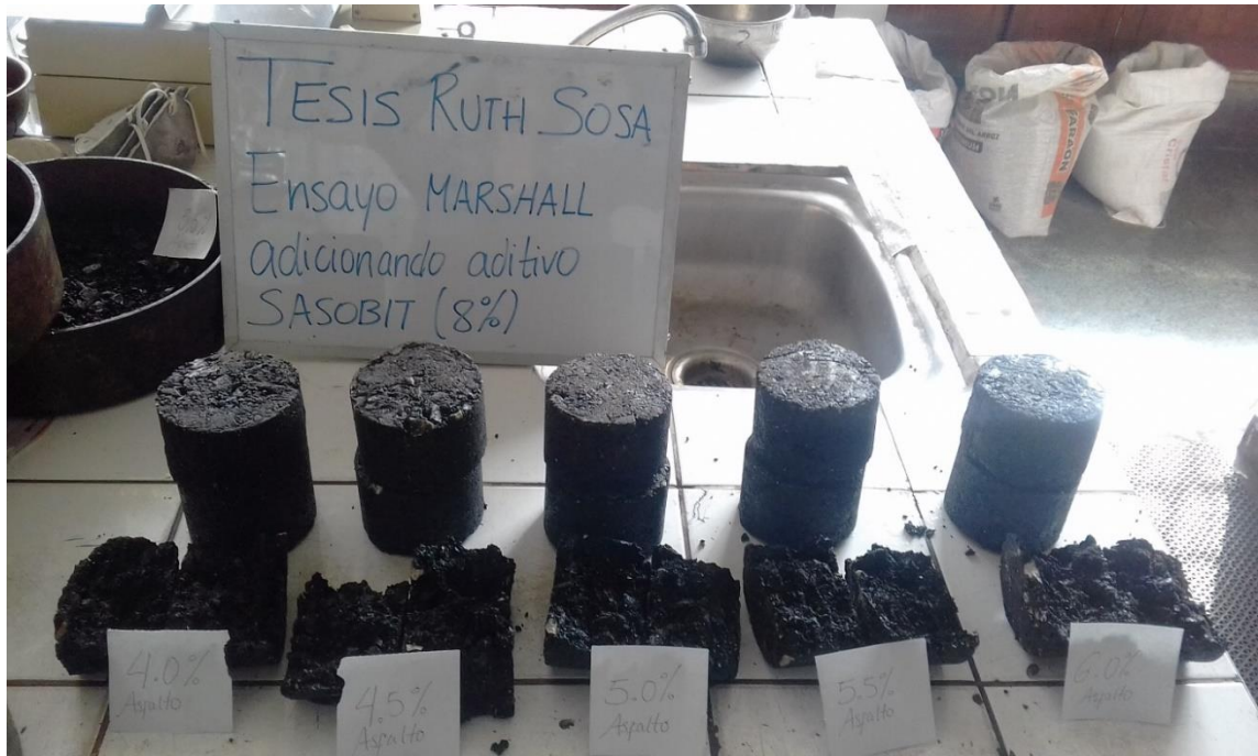
Figura 60: Briquetas, mezcla asfáltica convencional adicionando aditivo Sasobit
