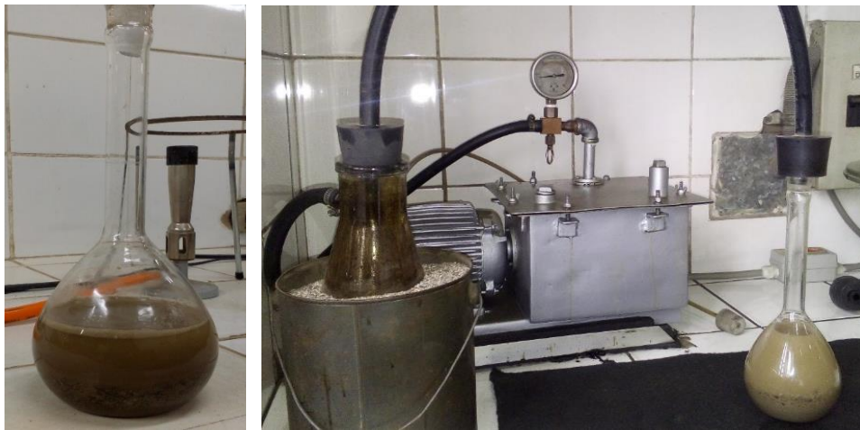
Figura 30: Extracción de vacíos
