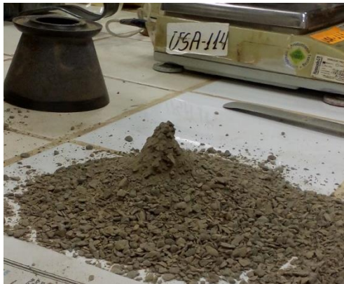
Figura 29: Material con presencia de humedad
