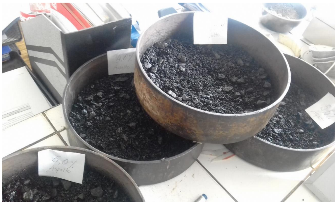
Figura 61: Rice, mezcla asfáltica convencional adicionando aditivo Sasobit
