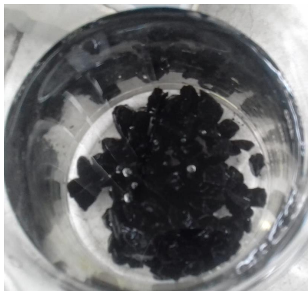
Figura 31: Agregado grueso recubierto con cemento asfáltico
