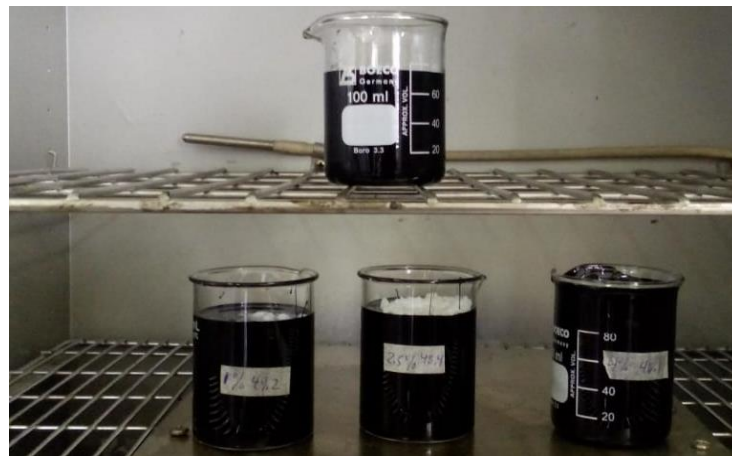
Figura 33: Cemento asfáltico con 1%, 2.5% y 4% Sasobit, temperatura 115°C
