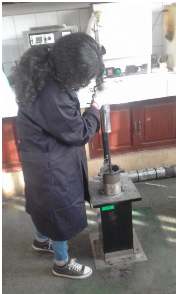
Figura 53: Compactación de la mezcla asfáltica
