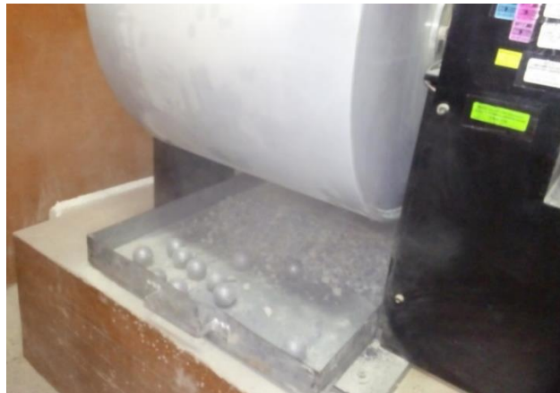
Figura 22: Agregado después de la máquina de Los Ángeles
