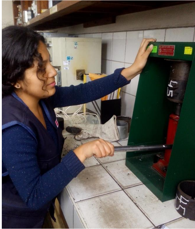
Figura 54: Extracción de briquetas
