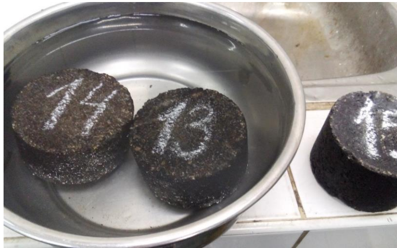
Figura 42: Briquetas sumergidas en agua temperada 25°C
