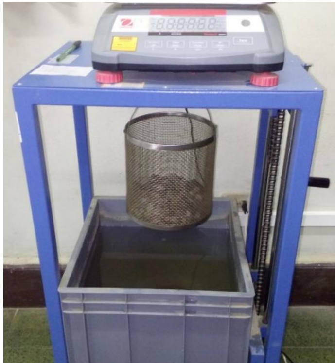
Figura 24: Agregado colocado en la canastilla
