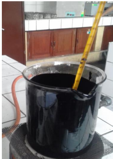
Figura 51: Medida de temperatura de cemento asfáltico con aditivo Sasobit
