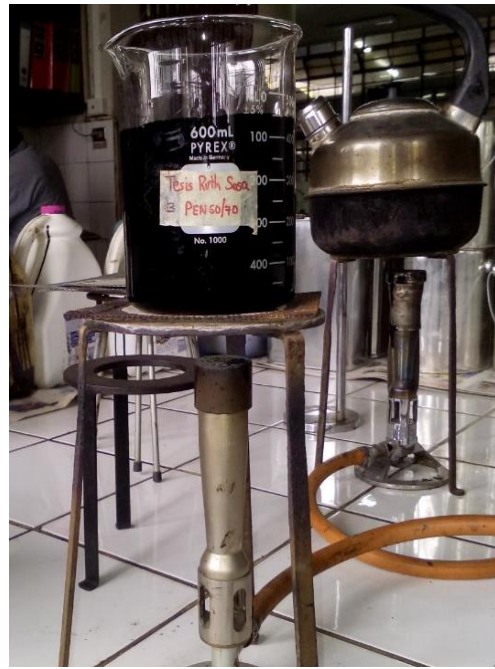
Figura 38: Asfalto PEN 60/70, procedencia Repsol
