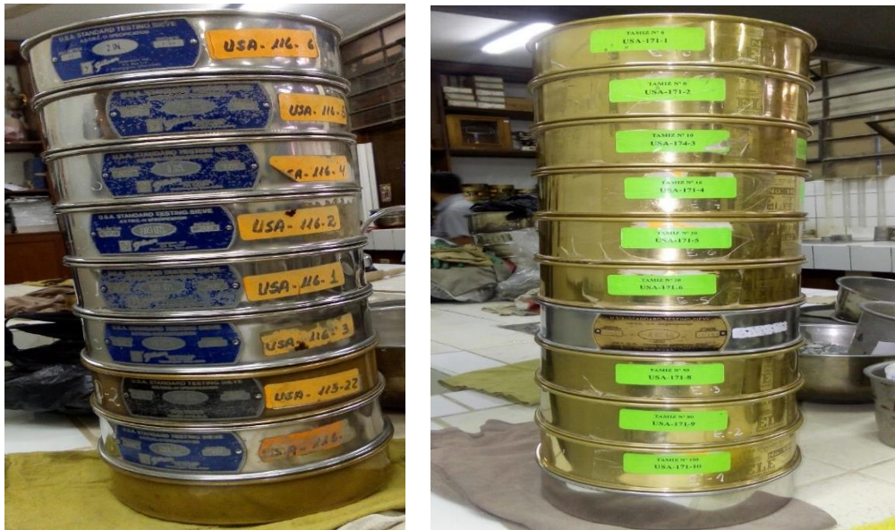
Figura 21: Tamizado del agregado grueso y fino
