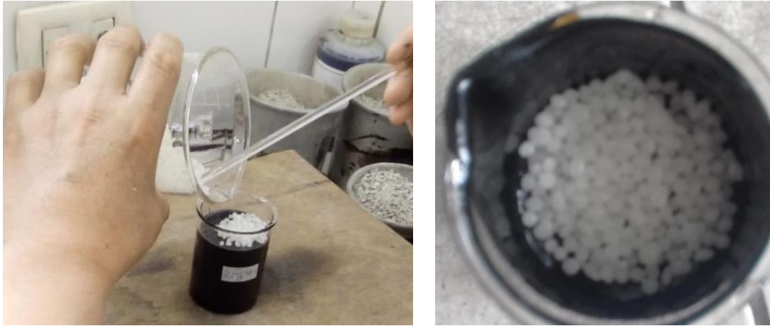
Figura 32: Incorporación de aditivo Sasobit al cemento asfáltico
