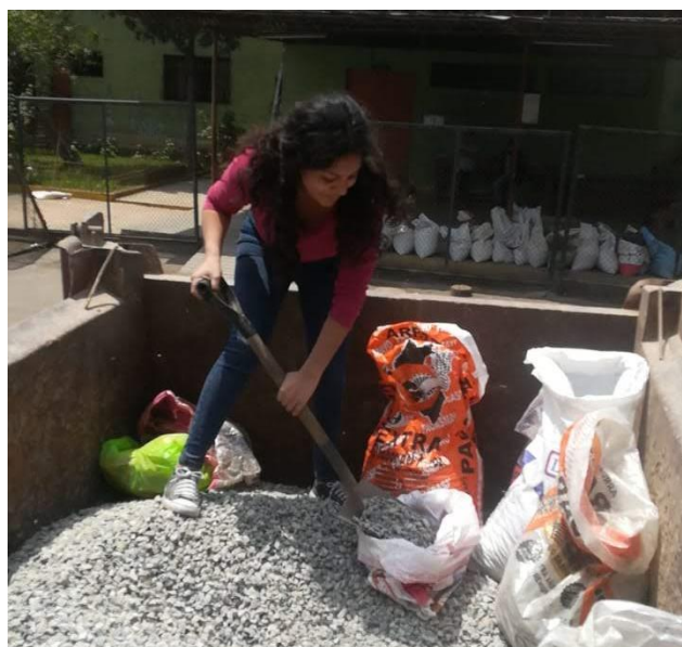
Figura 20: Colocación de agregados en bolsas para sus respectivos ensayos de calidad
