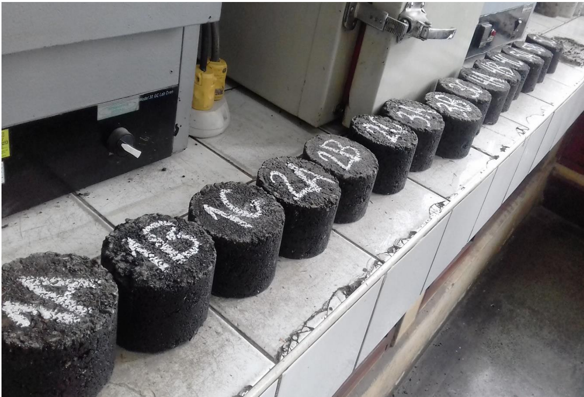
Figura 55: Briquetas de la mezcla asfáltica adicionando 8% Aditivo Sasobit
