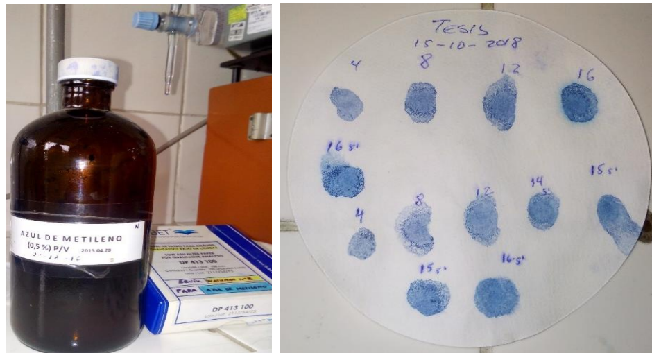
Figura 26: Azul de metileno y papel de filtro (Wathman N°2)
