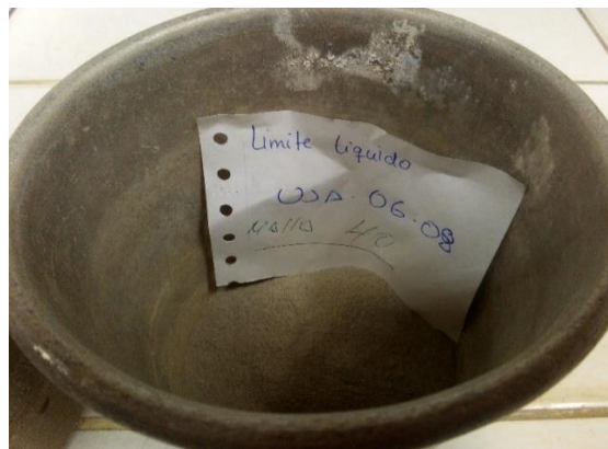
Figura 27: Agregado fino retenido en la malla N° 40
