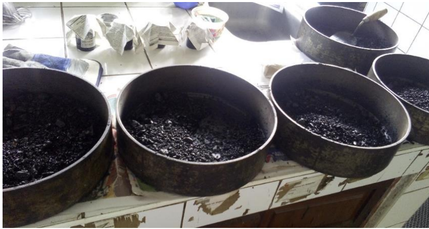
Figura 46: Especímenes para el ensayo de peso específico máximo (RICE)
