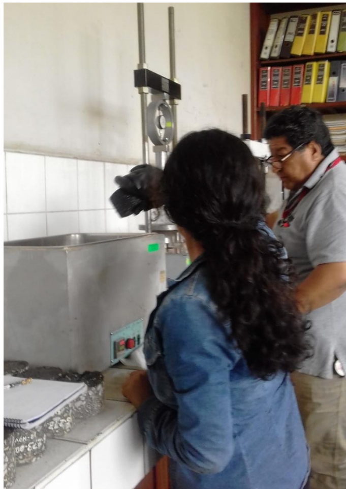
Figura 59: Retiro de briquetas para la cara a compresión
