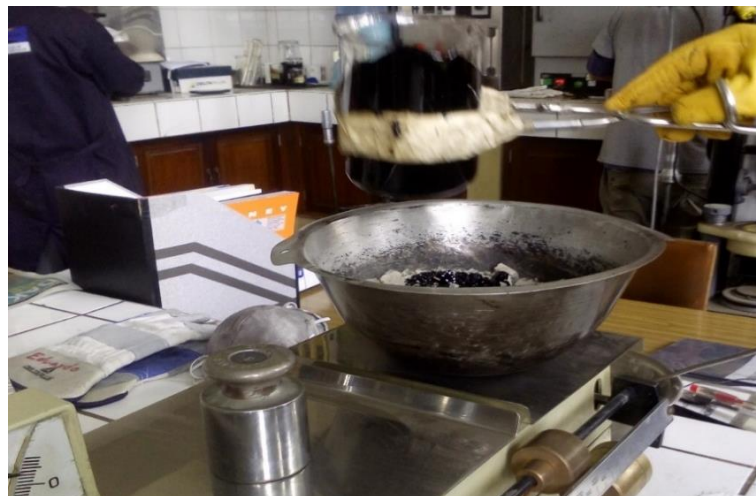
Figura 40: Agregado adicionando asfalto
