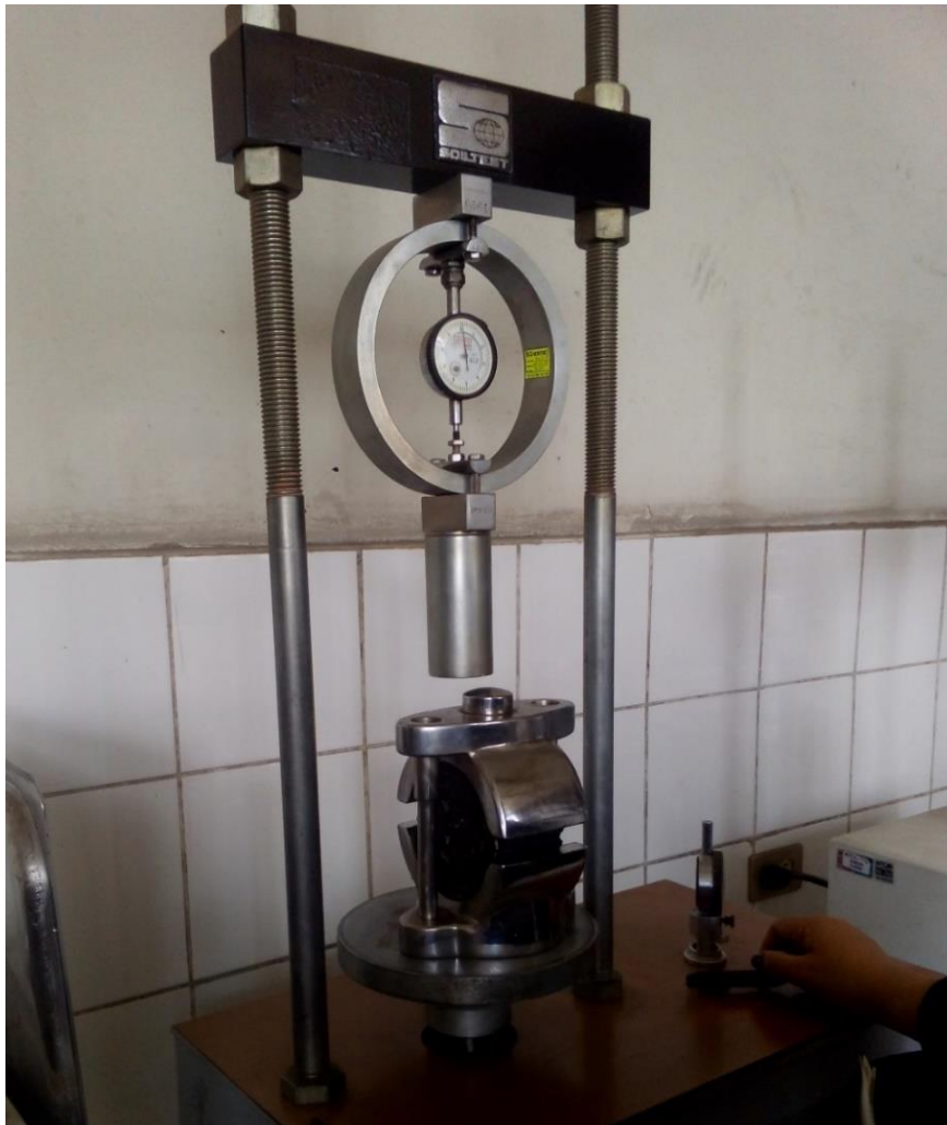
Figura 45: Máquina de Carga a Compresión
