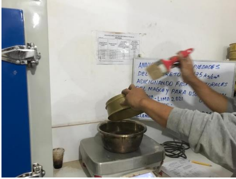
Fotografía 7: Tamizado del agregado fino
