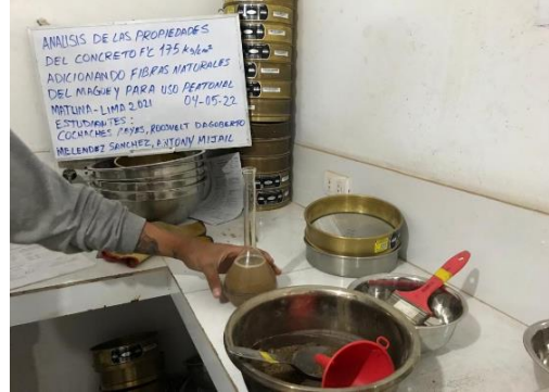
Fotografía 8: Peso específico de agregado fino
