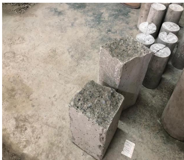
Figura 40. Viga ensayada Fuente: Elaboración propia.
