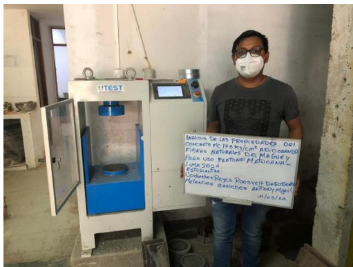
Fotografía 27: Equipo para rupturas de las muestras (probetas)
