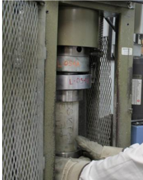
Figura 9. Rotura de probetas a compresión
