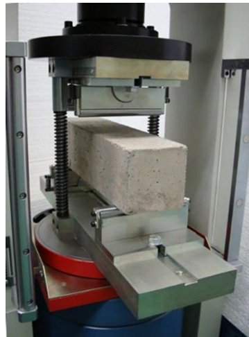
Figura 11. Ensayo de resistencia a flexión
