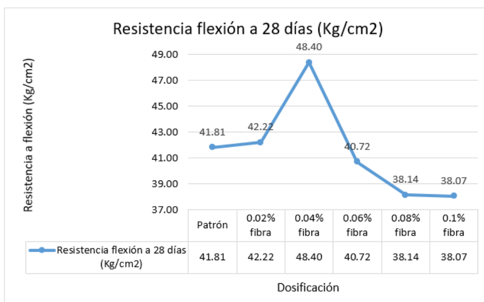
Figura 41. Resistencia a flexión de las muestras a 28 días
