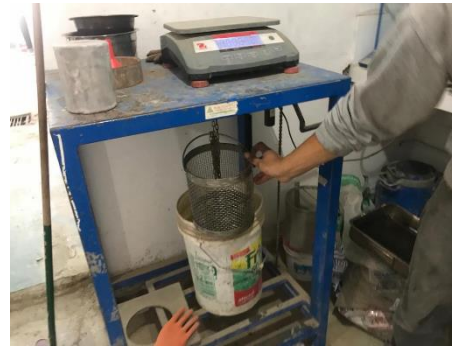
Fotografía 14: Gravedad específica del agregado grueso
