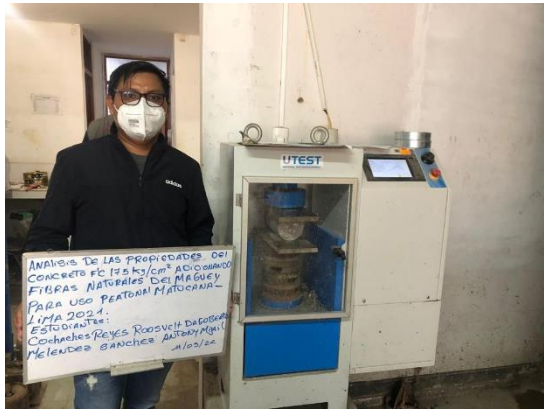
Fotografía 31: Ruptura de probetas por tracción
