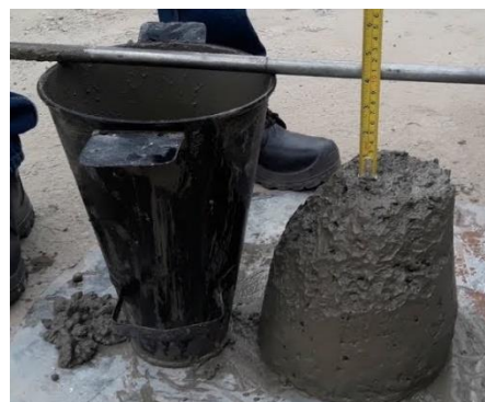
Figura 12. Ensayo de revenimiento o asentamiento
