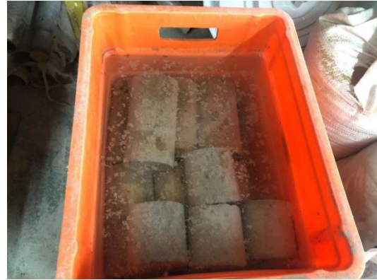
Fotografía 26: Curado de probetas
