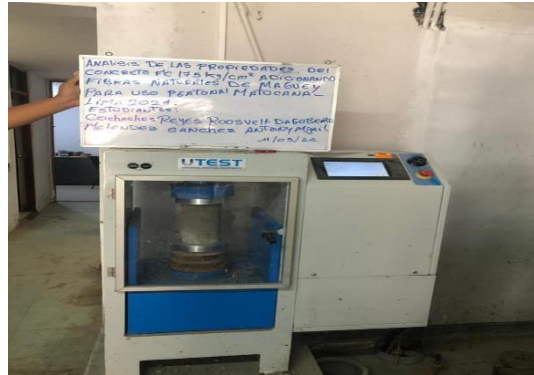
Fotografía 30: Rupturas de probetas a compresión
