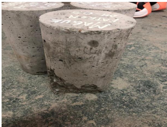
Fotografía 33: Probetas ensayadas a compresión
