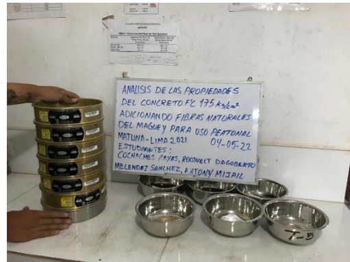
Figura 18. Tamizado de agregados Fuente: Elaboración propia.
