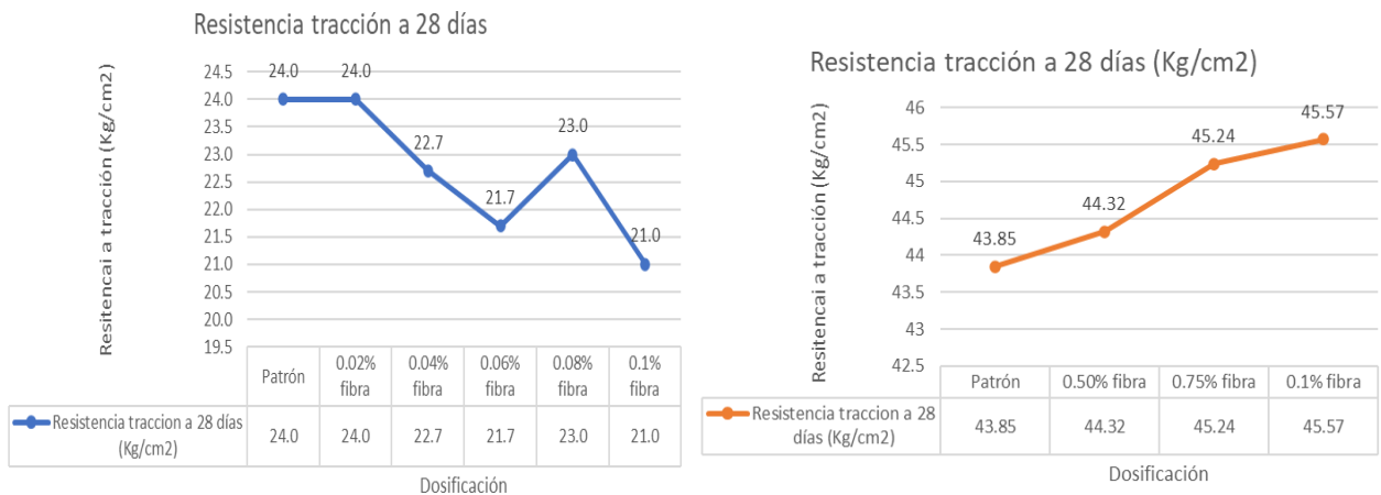
Figura 45. Comparación de resistencias a tracción con otras investigaciones.
