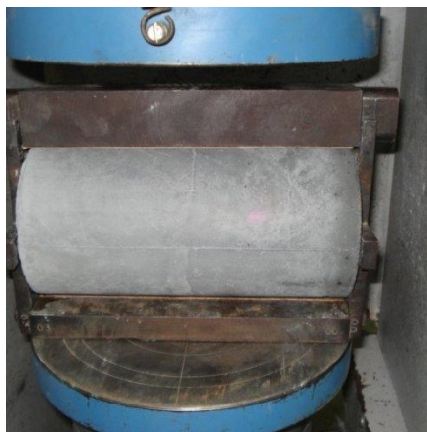
Figura 10. Rotura de probeta para resistencia a tracción diametral
