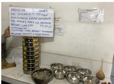
Fotografía 11: Tamizado de agregado grueso
