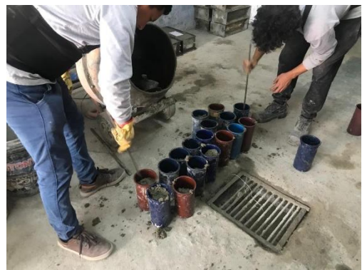
Fotografía 22: Vaciado de concreto
