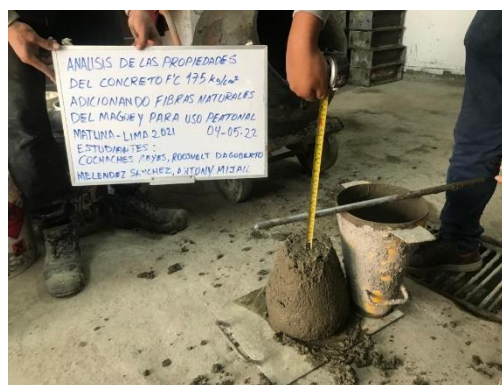
Figura 28. Medición del asentamiento Fuente: Elaboración propia.
