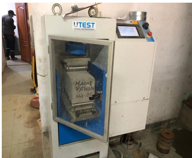
Figura 39. Ensayo de flexión Fuente: Elaboración propia.
