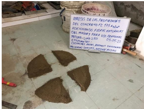
Figura 17. Cuarteo de agregado fino Fuente: Elaboración propia.
