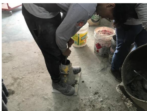
Figura 27. Ensayo de revenimiento Fuente: Elaboración propia.
