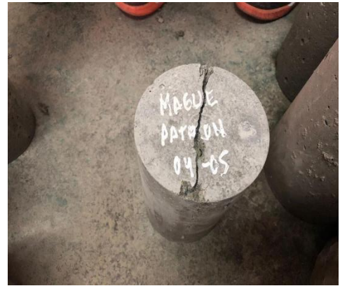
Fotografía 32: Ruptura de probetas por tracción
