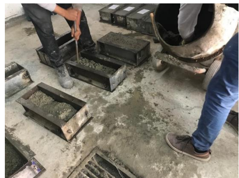
Fotografía 24: Vaciado de vigas de concreto
