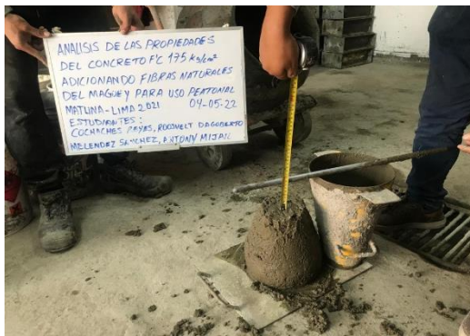
Fotografía 21: Slump del concreto
