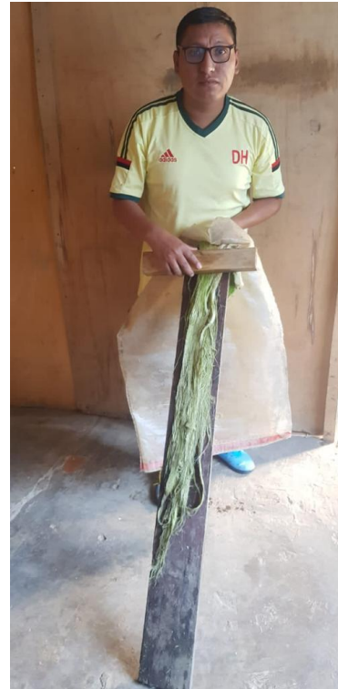
Figura 15. Raspado y eliminado de pulpa Fuente: Elaboración propia.
