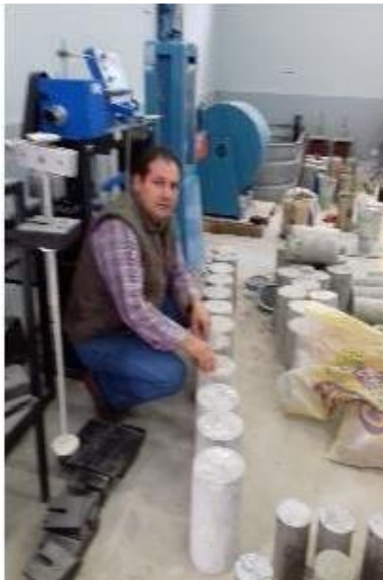
Figura 25: Acondicionamiento de probetas previo al ensayo de resistencia a la compresión.
