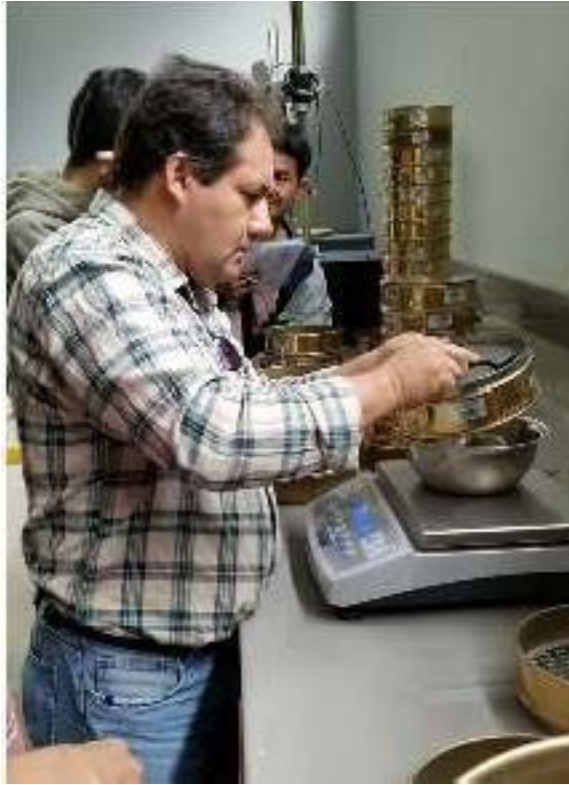
Figura 10: Retiro de agregado atrapado en el tamiz para su debido control del peso.
