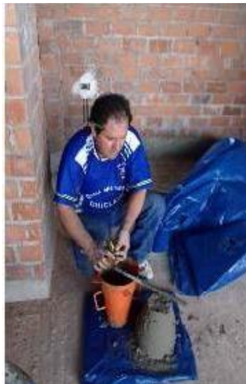
Figura 21: Acondicionamiento para la toma de medida de asentamiento.
