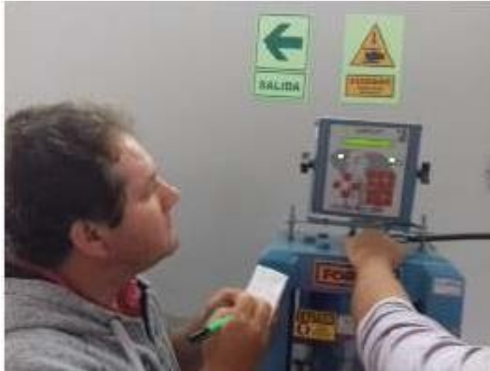
Figura 30: Registro de datos de carga aplicada por la compresora.
