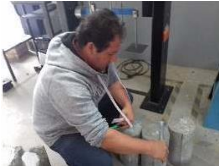
Figura 29: Verificación de dimensiones de probetas.
