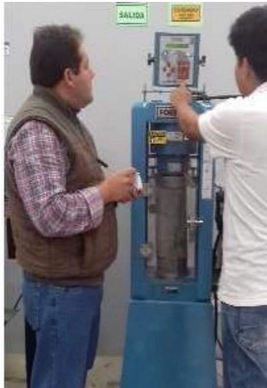
Figura 26: Aplicación de carga constante a la probeta ensayada.
