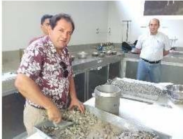
Figura 12: Selección preliminar del agregado para el ensayo de peso específico.
