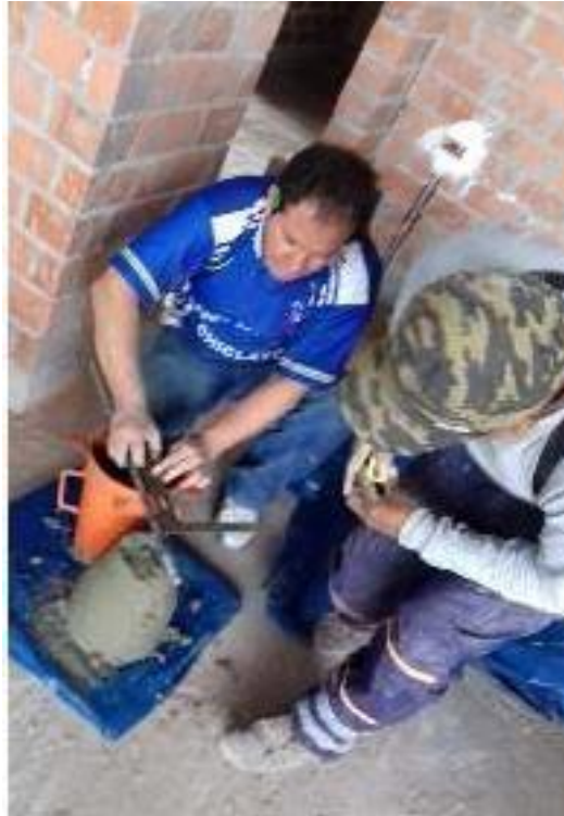
Figura 22: Verificación del nivel de la varilla de referencia durante el ensayo de asentamiento.
