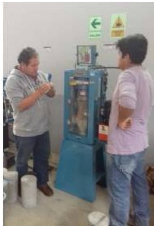
Figura 27: Registro de lectura de datos durante el ensayo de resistencia a la compresión.
