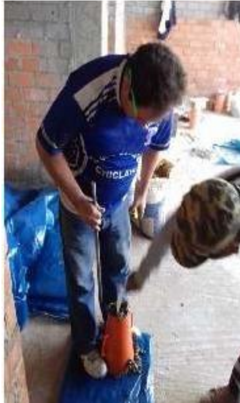
Figura 20: Ensayo de asentamiento.
