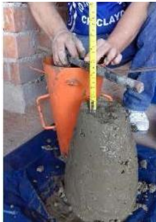
Figura 23: Toma de medida de asentamiento.
