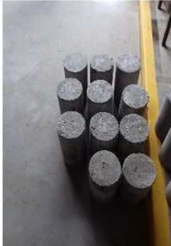
Figura 28: Probetas de concreto, sujetas al ensayo de resistencia a la compresión.
