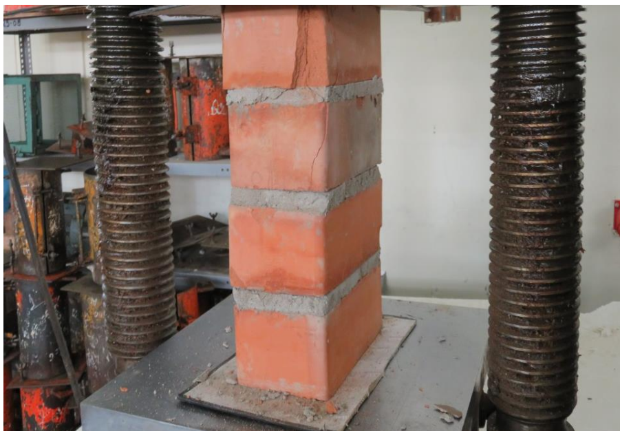
Falla a compresión axial de pila de albañilería N° 03, preparada con mortero cuya arena es de la cantera Rio Utcubamba. La falla se propaga desde el ladrillo superior hacia los ladrillos inferiores.
