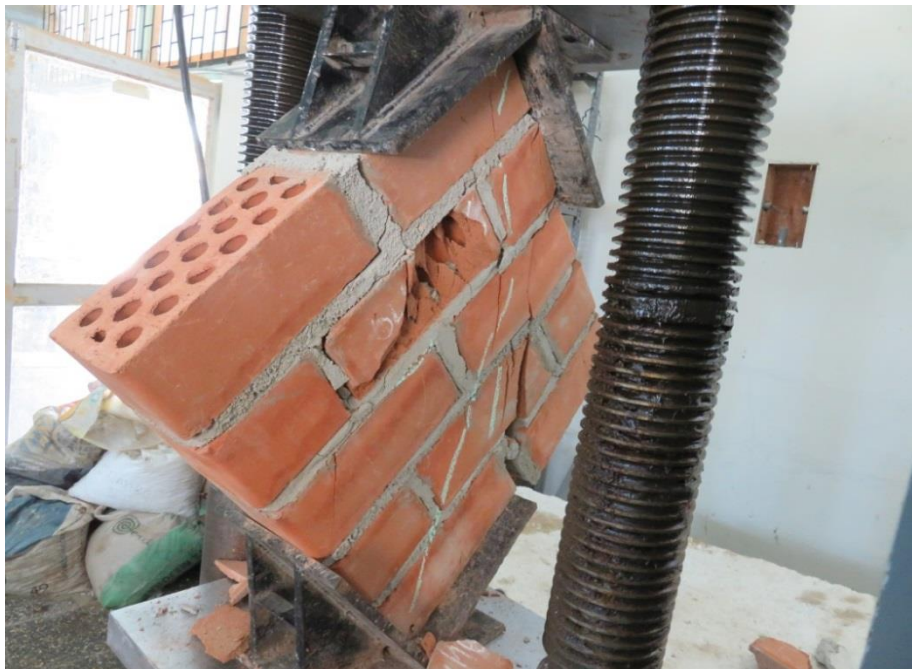
Falla a compresión diagonal de murete de albañilería N° 01, preparada con mortero cuya arena es de la cantera cerro colorado. La falla se inicia en los ladrillos de las dos últimas hiladas.
