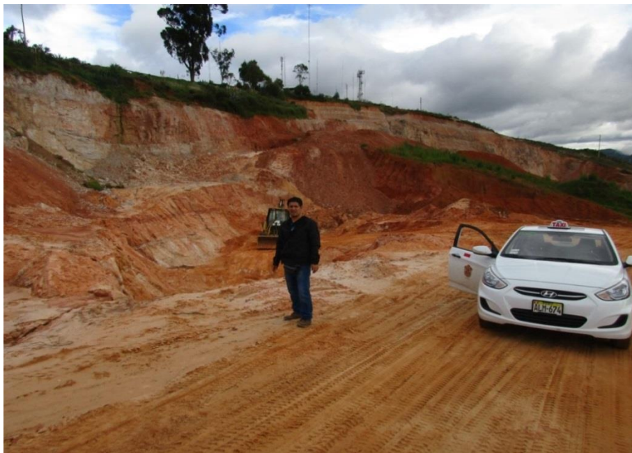
Vista de la Cantera “Cerro Colorado” localizada en las cercanías a la ciudad de Chachapoyas, en donde se explota arena para morteros (arena colorada) y arena para tarrajeos (arena blanca)
