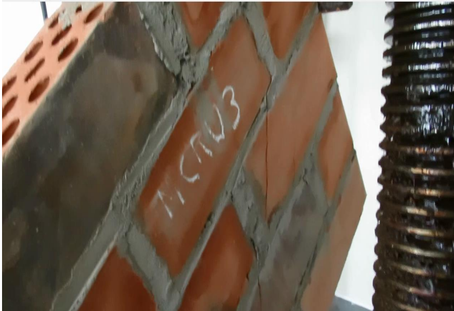
Inicio de falla a compresión diagonal de murete de albañilería N° 03, preparada con mortero cuya arena es de la cantera Rio Utcubamba. La falla se inicia en los ladrillos de la tercera hilada.
