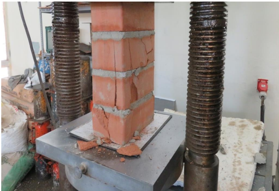
Falla a compresión axial de pila de albañilería N° 02, preparada con mortero cuya arena es de la cantera cerro colorado. La falla se inicia en el ladrillo inferior.
