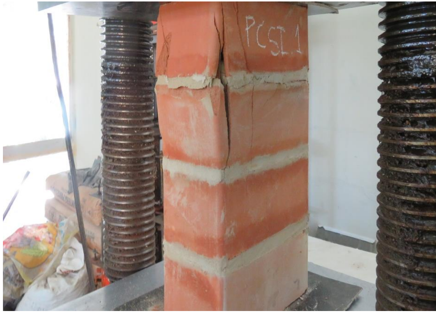
Falla a compresión axial de pila de albañilería N° 01, preparada con mortero cuya arena es de la cantera San Isidro. La falla se propaga desde el ladrillo superior hacia los ladrillos inferiores.
