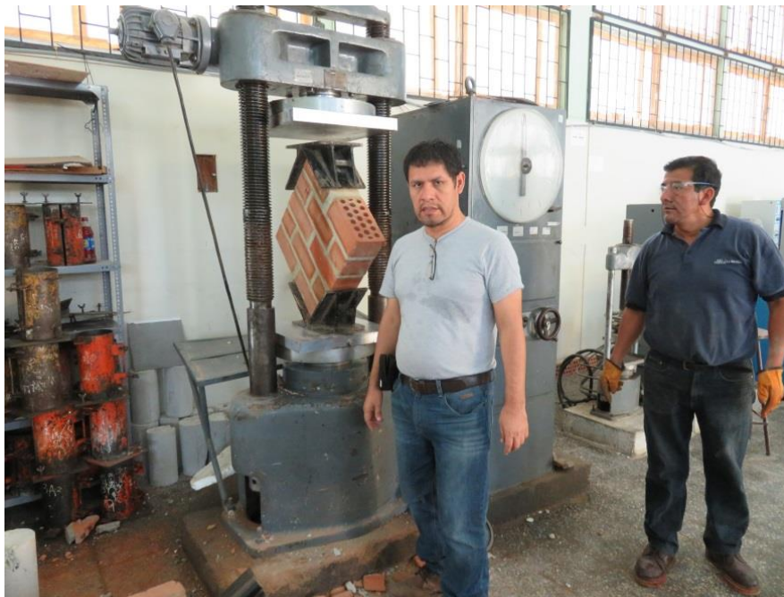
Murete de albañilería N° 01 listo para ser ensayado a compresión diagonal, el que ha sido preparada con mortero cuya arena es de la cantera San Isidro.
