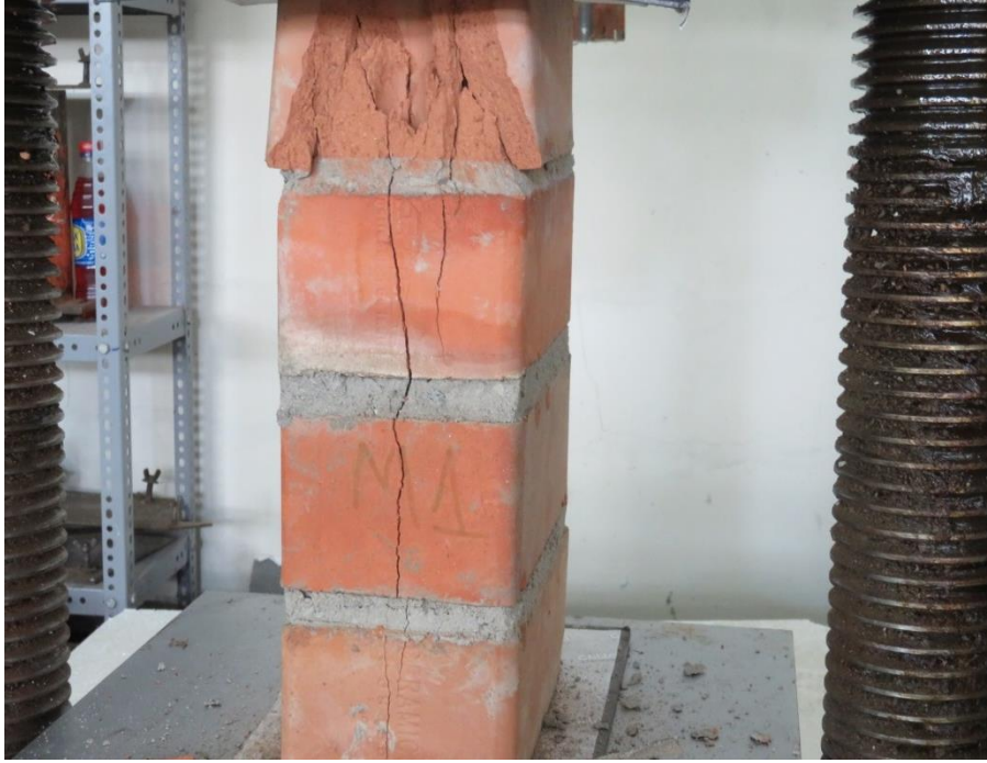
Inicio de falla a compresión axial de pila de albañilería N° 01, preparada con mortero cuya arena es de la cantera Rio Utcubamba. La falla se inicia en el ladrillo superior.
