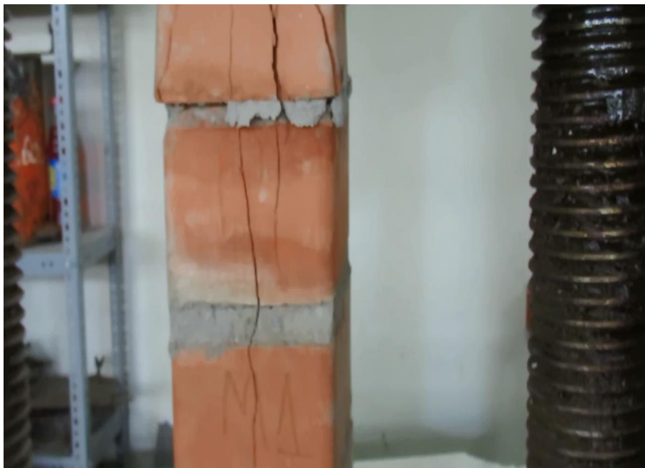
Falla a compresión axial de pila de albañilería N° 01, preparada con mortero cuya arena es de la cantera Rio Utcubamba. La falla se propaga desde el ladrillo superior hacia los ladrillos inferiores.
