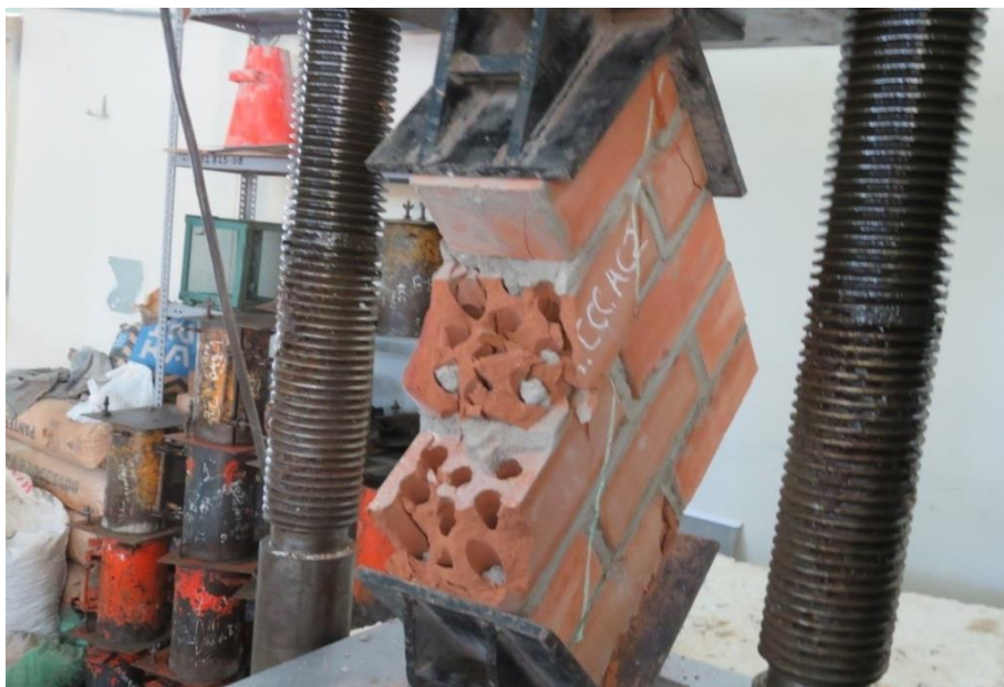
Formación de llaves de corte en las aberturas del ladrillo, las cuales le dan mayor resistencia al corte al murete N° 02.
