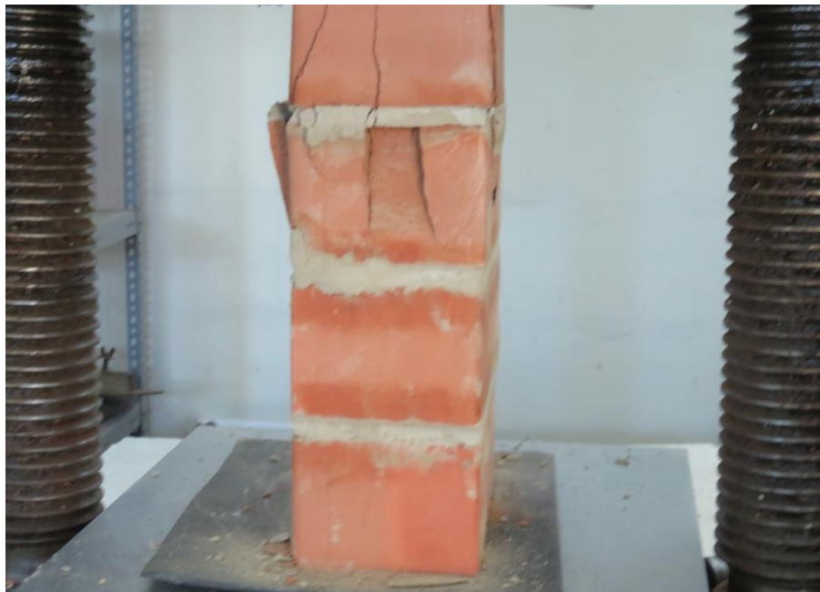
Falla a compresión axial de pila de albañilería N° 02, preparada con mortero cuya arena es de la cantera San Isidro. La falla se propaga desde el ladrillo superior hacia los ladrillos inferiores.
