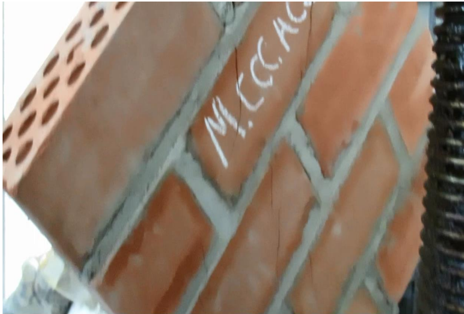
Inicio de falla a compresión diagonal de murete de albañilería N° 02, preparada con mortero cuya arena es de la cantera cerro colorado. La falla se inicia en los ladrillos de la segunda hilada.
