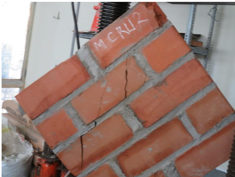
Falla a compresión diagonal de murete de albañilería N° 02, preparada con mortero cuya arena es de la cantera Rio Utcubamba. La falla se propaga desde la segunda hilada al resto del murete.
