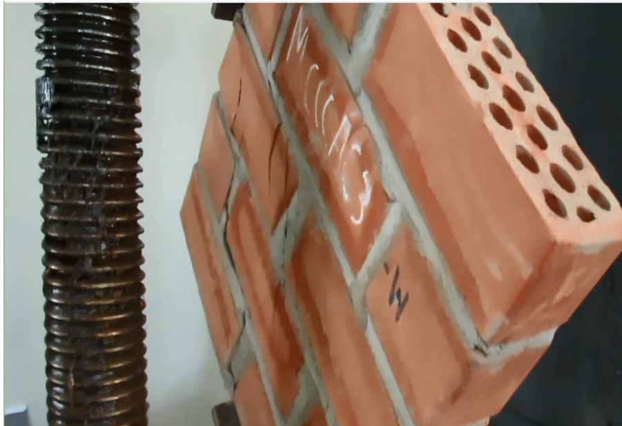
Falla a compresión diagonal de murete de albañilería N° 03, preparada con mortero cuya arena es de la cantera cerro colorado. La falla se propaga desde la segunda hilada al resto del murete.
