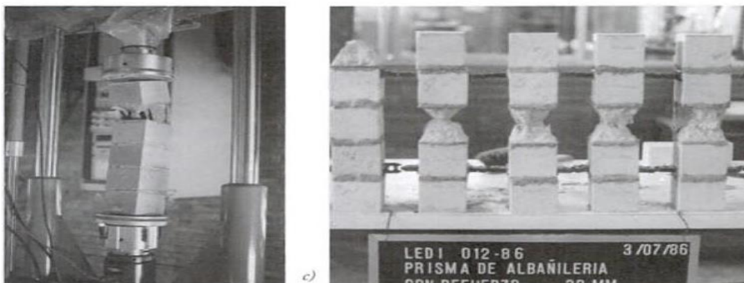
9.15. Prismas de albañilería con planchas de acero en las juntas [63]. a) Unidades y planchas. b) Ensayo a rotura por compresión. c) Testigos después del ensayo.
