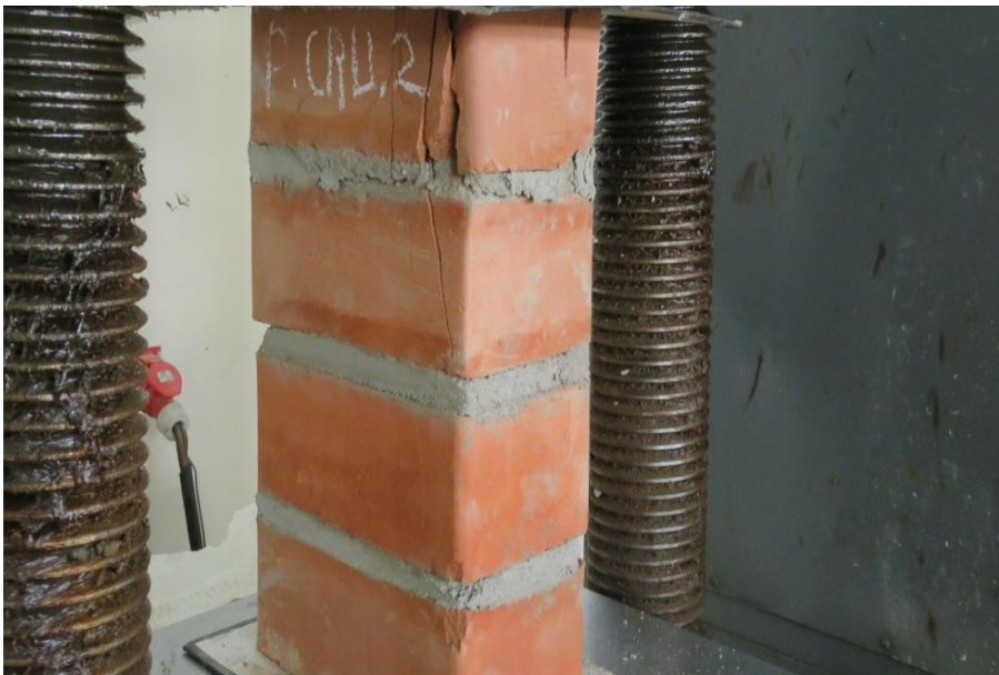
Falla a compresión axial de pila de albañilería N° 02, preparada con mortero cuya arena es de la cantera Rio Utcubamba. La falla se propaga desde el ladrillo superior hacia los ladrillos inferiores.
