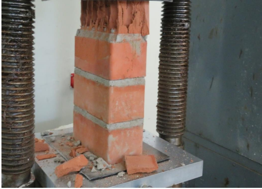
Falla a compresión axial de pila de albañilería N° 01, preparada con mortero cuya arena es de la cantera cerro colorado. La falla se inicia en el ladrillo superior.
