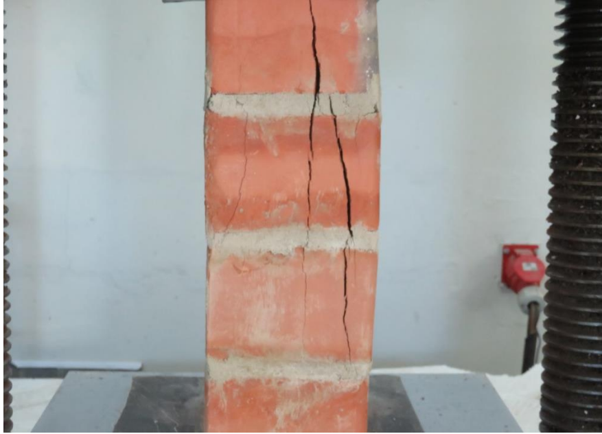
Falla a compresión axial de pila de albañilería N° 03, preparada con mortero cuya arena es de la cantera San Isidro. La falla se propaga desde el ladrillo superior hacia los ladrillos inferiores.
