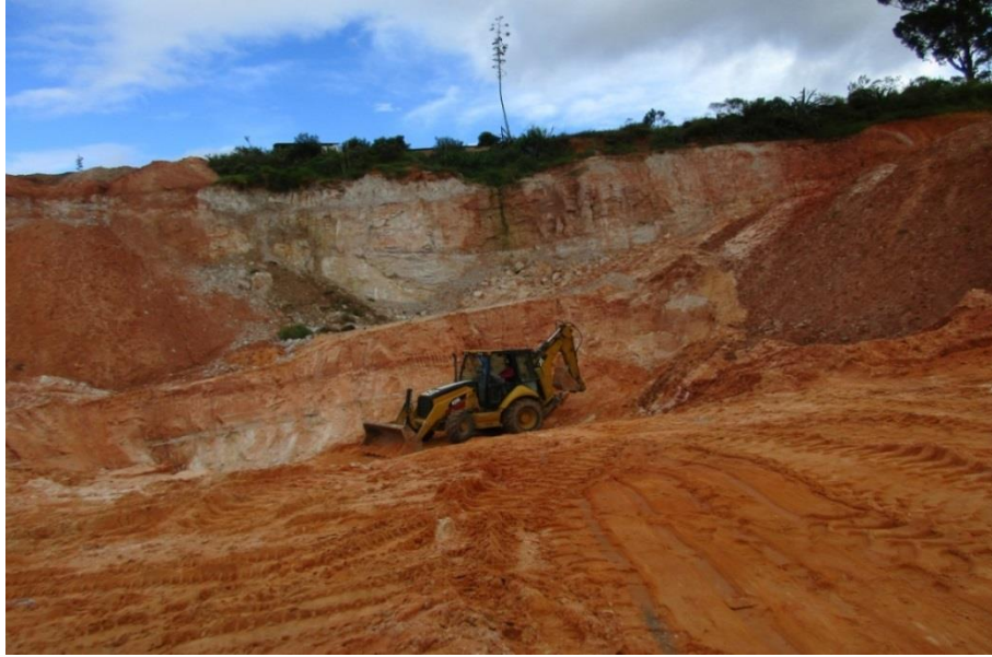
Vista de la Cantera “Cerro Colorado” localizada en las cercanías a la ciudad de Chachapoyas, en donde se explota arena para morteros (arena colorada) y arena para tarrajeos (arena blanca)
