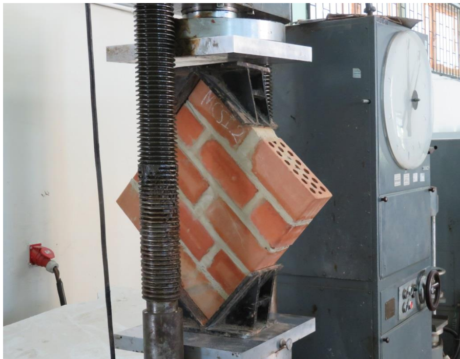
Murete de albañilería N° 02 listo para ser ensayado a compresión diagonal, el que ha sido preparada con mortero cuya arena es de la cantera San Isidro.
