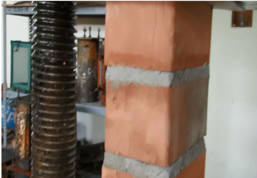
Inicio de falla a compresión axial de pila de albañilería N° 03, preparada con mortero cuya arena es de la cantera Rio Utcubamba. La falla se inicia en el ladrillo superior.
