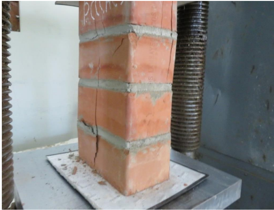
Falla a compresión axial de pila de albañilería N° 03, preparada con mortero cuya arena es de la cantera cerro colorado. La falla se propaga desde el ladrillo inferior hacia los ladrillos superiores
