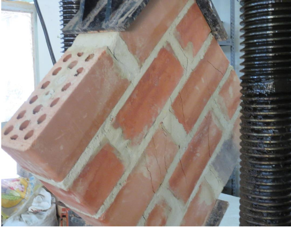
Falla a compresión diagonal de murete de albañilería N° 02, preparada con mortero cuya arena es de la cantera San Isidro. La falla se inicia en los ladrillos de la tercera hilada.
