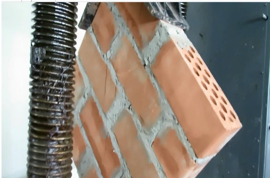
Falla a compresión diagonal de murete de albañilería N° 03, preparada con mortero cuya arena es de la cantera Rio Utcubamba. La falla se propaga desde la tercera hilada al resto del murete.
