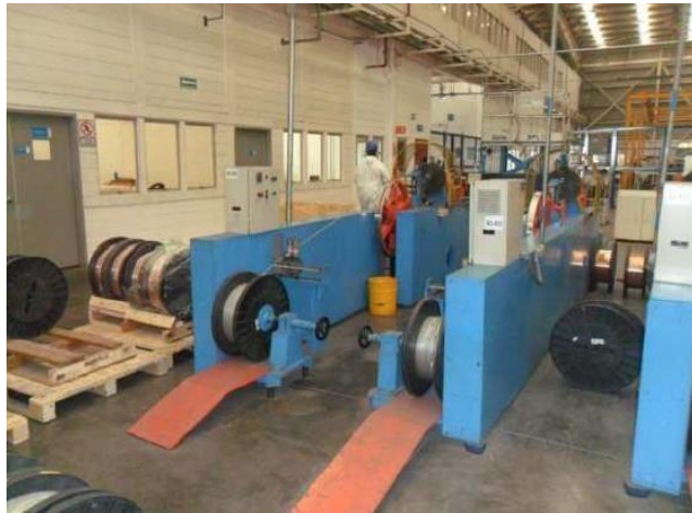
Proceso de encintado de los conductores de Cobre
