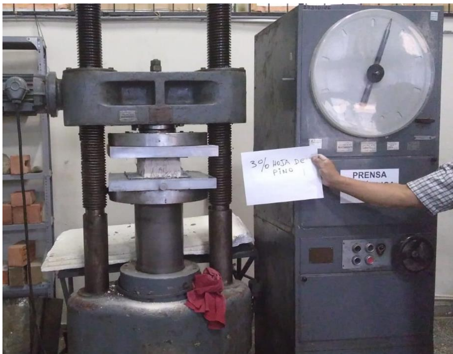
Imagen 12. Ensayo a compresión adobe con 3% adición hojas de pino
