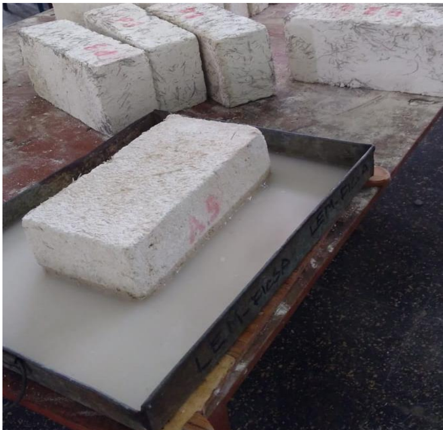
Imagen 24. Succión de Agua adobe con 3% de adición aserrín
