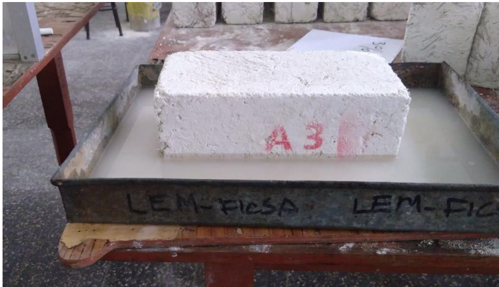
Imagen 23. Succión de Agua adobe con 3% de adición aserrín
