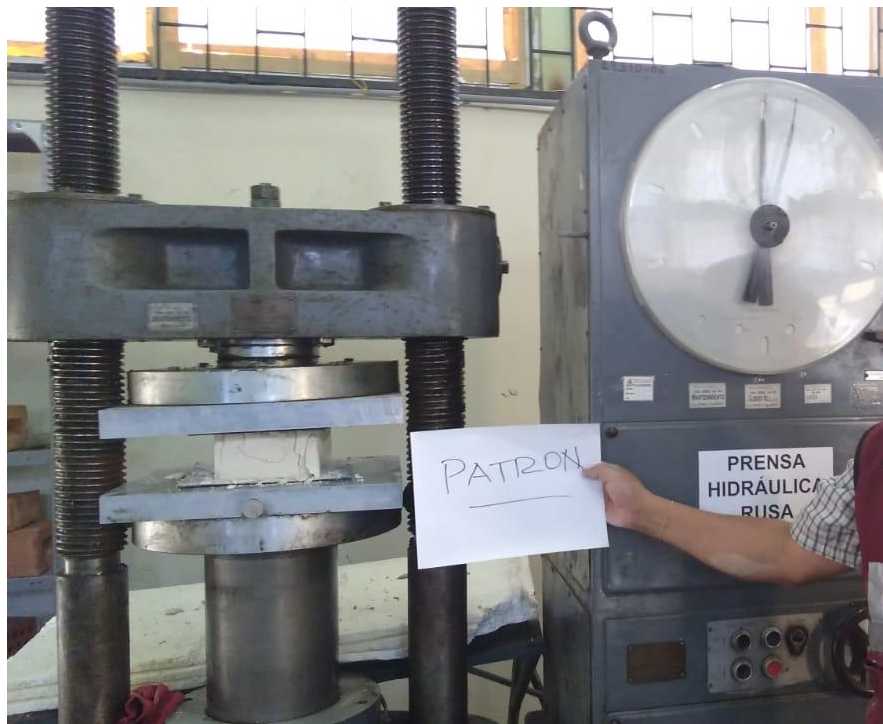
Imagen 10. Ensayo a compresión adobe 0% fibra vegetal
