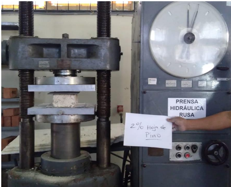
Imagen 11. Ensayo a compresión adobe con 2% adición hojas de pino
