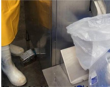
**Figura 16:** Nuevo pedal de máquina lavadora
