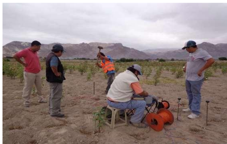
Vista de ejecución de sondaje eléctrico 3
