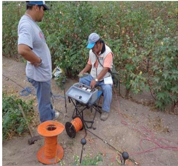
Vista de ejecución de sondaje eléctrico 1
