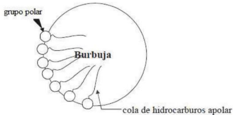
Fig. 9: adhesión del espumante a la partícula de aire.
