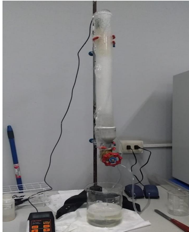
Fig. 22: una vez regulada el pH empieza a burbujear inmediatamente, en la etapa de burbujeo se libera el boro con el quitosano, el tiempo de burbujeo tiene un periodo de tiempo de aproximadamente de media hora, la burbuja se almacena en el vaso precipitado.
