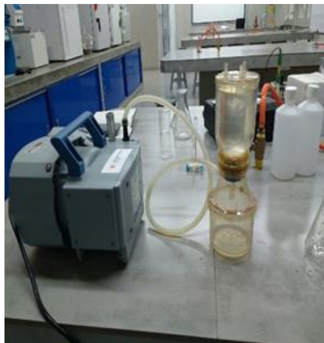
Fig. 23: una vez obtenida la muestra, ojo que la muestra es lo que queda en el interior del tubo, pues se filtra la muestra haciendo uso de la bomba de filtro y papel filtro (recomendable usar doble hoja).
