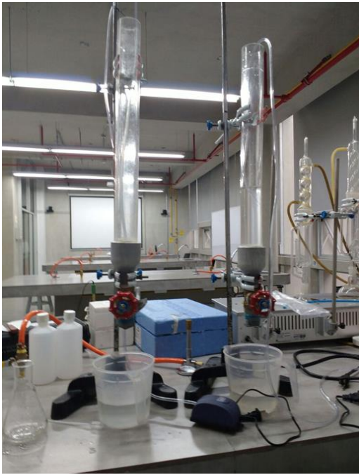
Fig. 20: una vez vertido la muestra de agua con boro en el tubo, se agrega el quitosano
