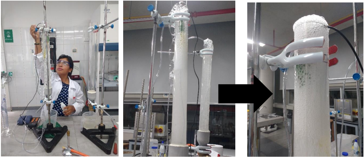
Fig.16. ajuste de pH de la muestra utilizando ácido acético al 5%.
