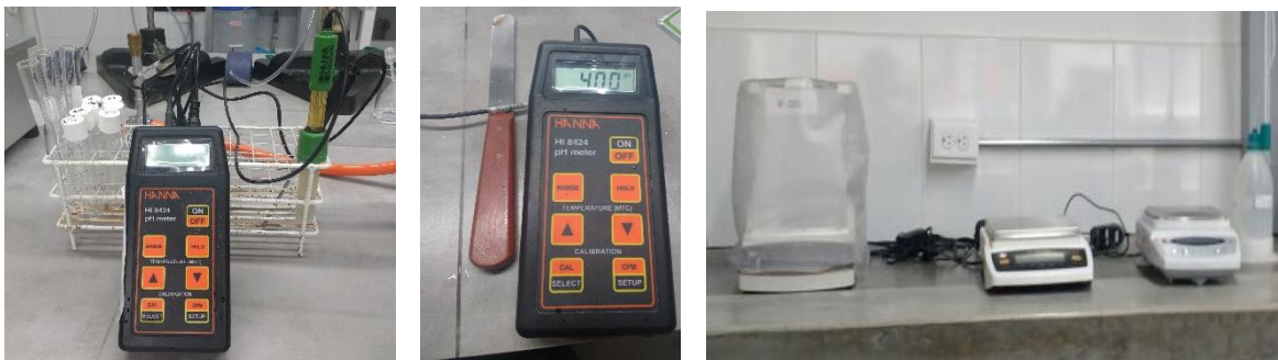
Fig.13. instrumentos de medición de laboratorio (pH metro, balanza analítica y agitador magnético).
