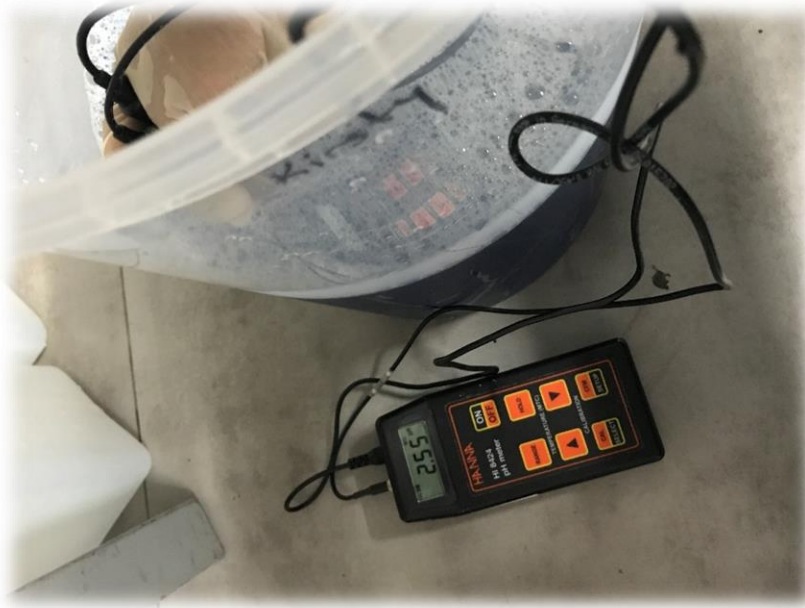
Figura N° 8: Acidificación de la muestra
