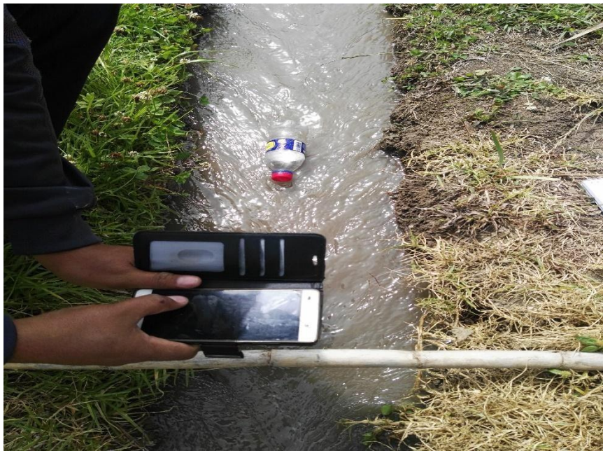
Figura 39. Obtención de datos según el método del flotador para determinar el caudal de agua a utilizar en riego por inundación en el cultivo de granadilla en el Centro Poblado de Yuracyacu – Chota.
