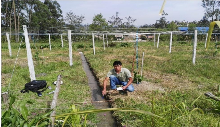
Figura 38. Toma de datos del canal N° 01 para cálculos en riego por inundación en el cultivo de granadilla en el Centro Poblado de Yuracyacu – Chota.
