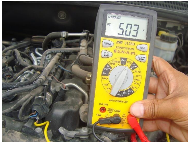
Comprobación del voltaje referencial del sensor de presión de riel común
