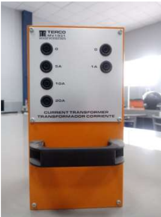
TRANSFORMADOR DE CORRIENTE 02 UNIDADES
